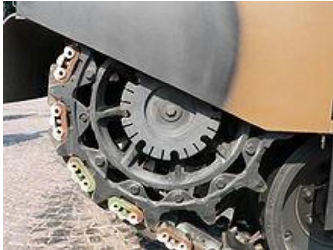
Slika 2.5 Pogonski lančanik od Leclerc glavnog tenka (2006).
