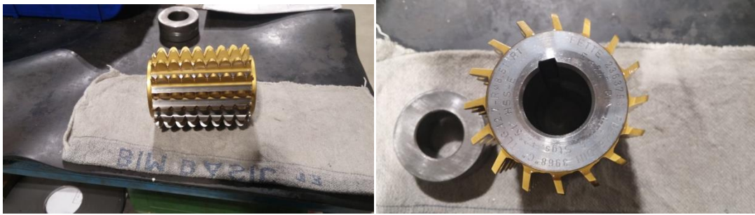
Slika 4.18 Glodalo za izradu zubi na lančaniku
