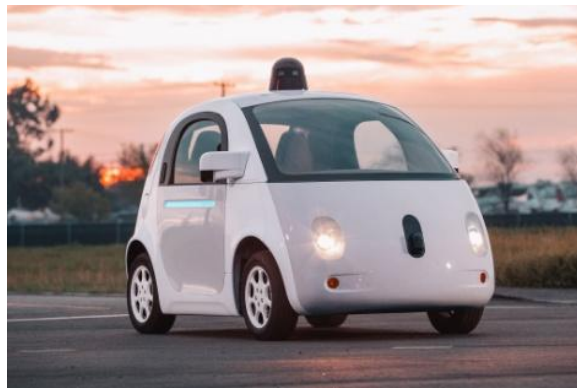
Slika 28. Prototip tvrtke Google potpuno autonomnog cestovnog vozila
