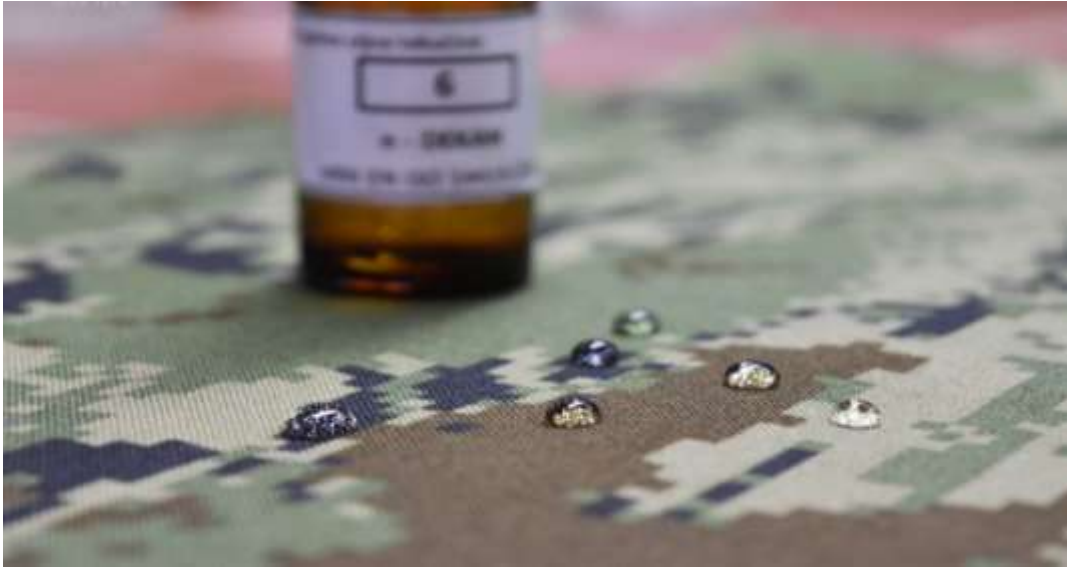
Fotografija 4.11.: Laboratorijsko ispitivanje tkanine
