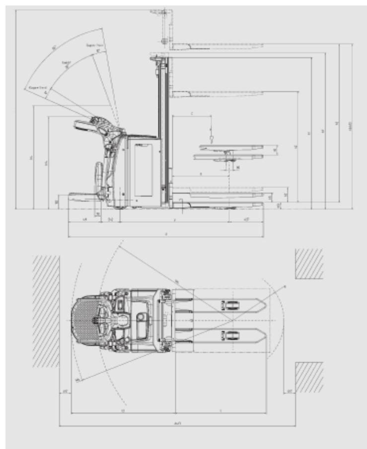
Slika 29. Nacrt visokopodiznog viličara Linde L14 AP[11]
