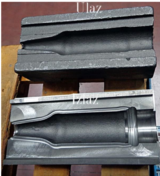
Fotografija 5: Glodanje prije navarivanja - ulaz i izlaz
