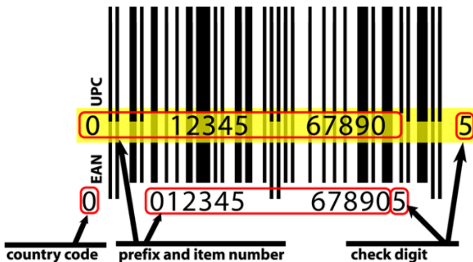
Slika 15: Struktura crtičnih kodova EAN-13 i UPC-A
