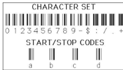
Slika 8: Kodiranje znakova kod Codabar-a
