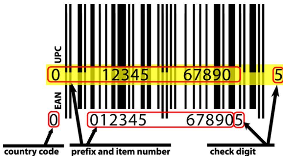
Slika 15: Struktura crtičnih kodova EAN-13 i UPC-A
