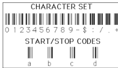
Slika 8: Kodiranje znakova kod Codabar-a
