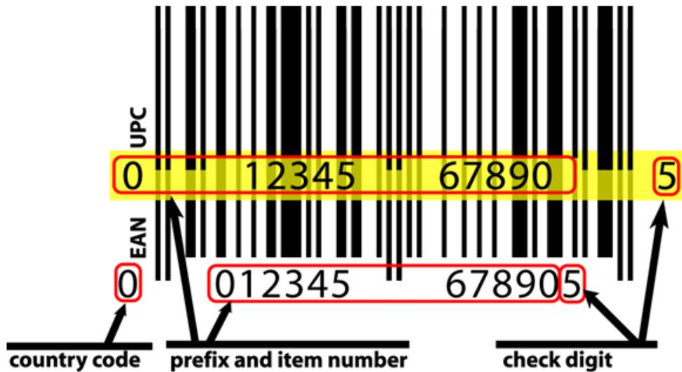
Slika 15: Struktura crtičnih kodova EAN-13 i UPC-A
