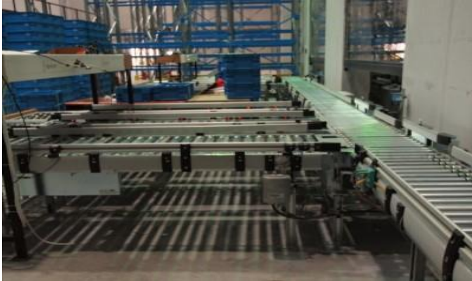
Slika 5. Pokretne trake s automatskim sortiranjem [9]
