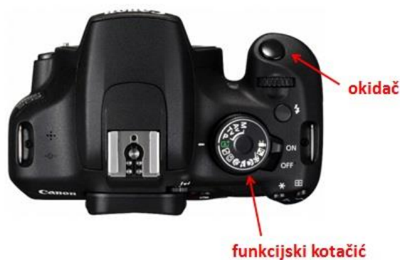
Slika 6.3 - Prikaz okidača i funkcijskog kotačića
