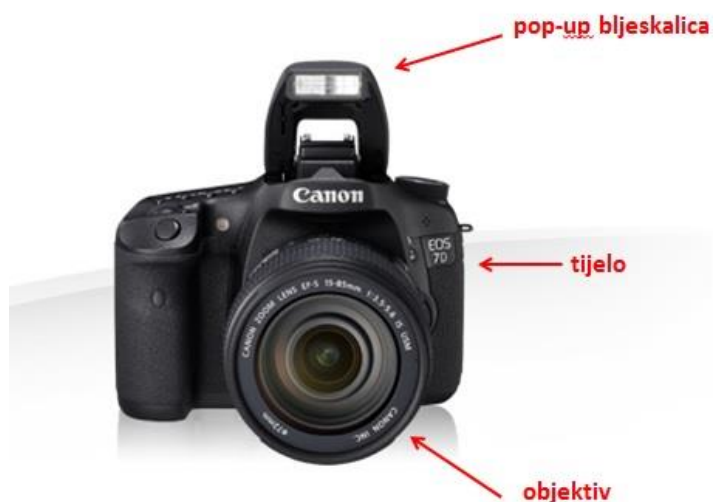
Slika 6.2 - Prikaz pop-up bljeskalice, tijela fotoaparata i objektivna
