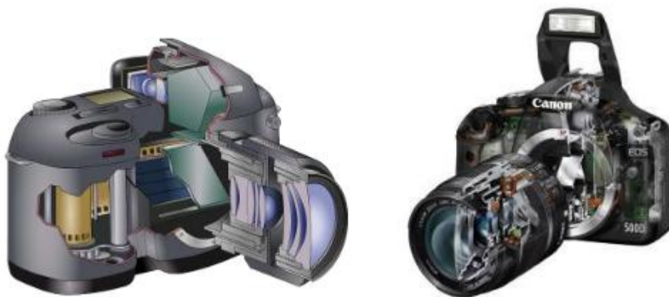
Slika 3.1 Presjek SLR-a i DSLR-a
