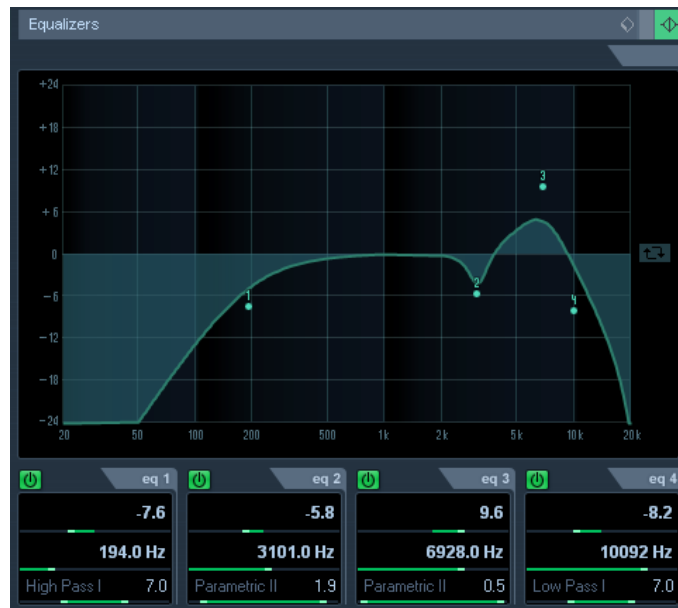
Slika 41.postavke ekvalizacije prve audio trake pick gitare.
