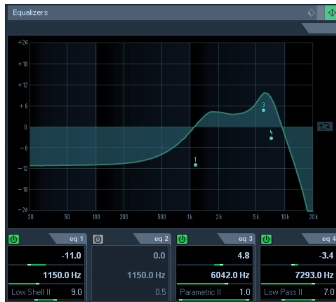
Slika 35. prikaz postavka ekvalizacije za prvu audio traku ritam gitare.
