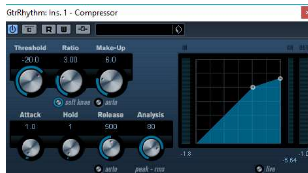
Slika 34. postavke kompresora prve audio trake ritam gitare.
