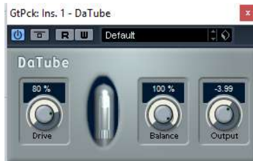
Slika 38. postavke DaTube audio efekta za obje trake dionice pick gitare.
