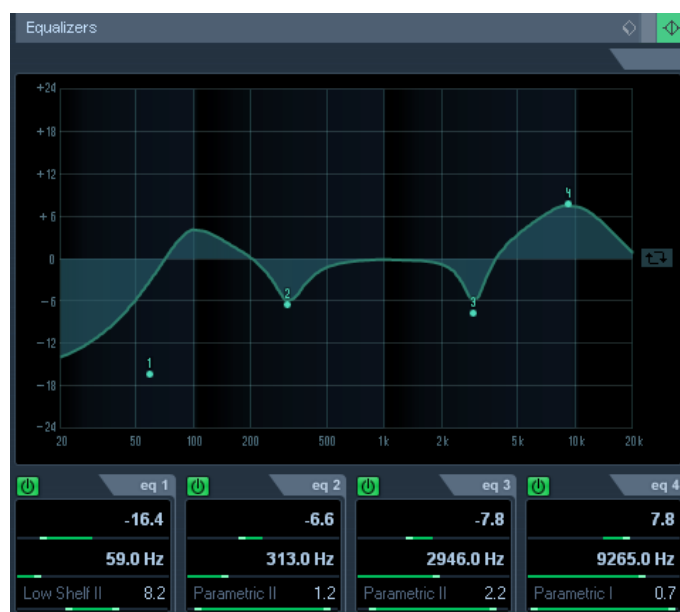
Slika 33. postavke ekvalizacije za prvu traku sporednog rifa.
