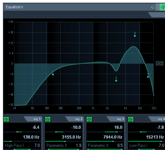
Slika 42.postavke ekvalizacije druge audio trake pick gitare.
