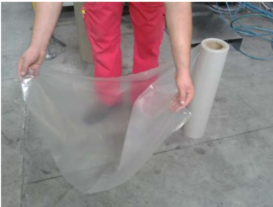
3.8 Folija dobivena crijevnim ekstrudiranjem [25]
