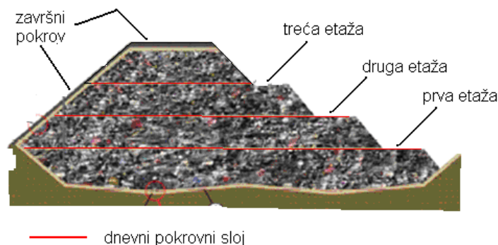
Slika 3.3.1. Prikaz dnevnog prekrivnog sloja (Izvor: Gotal Dmitrović, L. i sur., 2013.)
