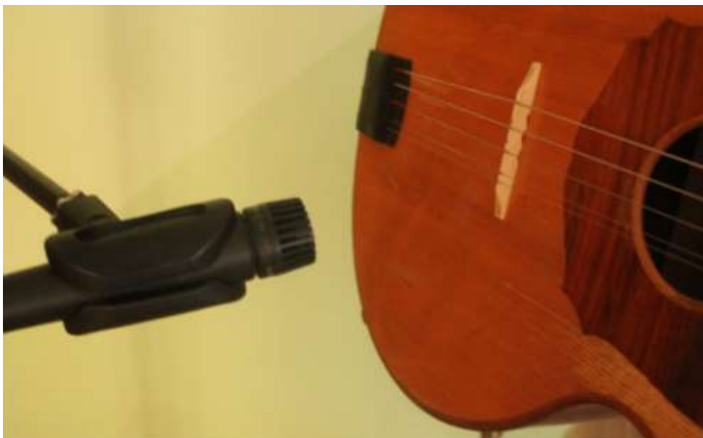
Slika 4.9 Pozicioniranje mikrofona za brač.
