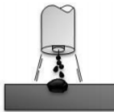
Slika 3.5. Prijenos metala mješovitim lukom – shematski prikaz[6]
