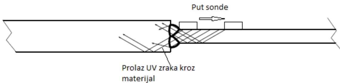
Slika 4.11 Shema ispitivanja K zavara između pozicije I i 2
