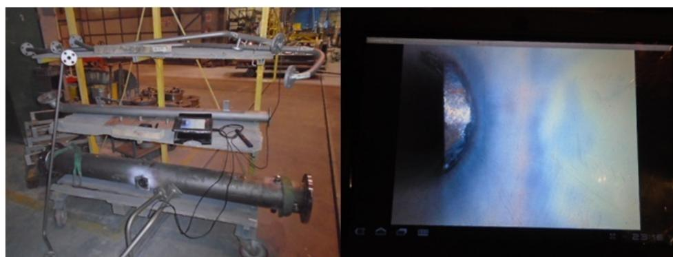
Slika 4.3. Kontrola provara u unutrašnjosti cijevi videoskopom
