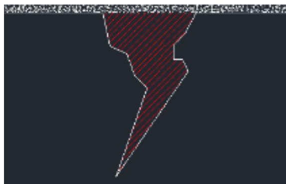
Slika 3.11 Nanošenje razvijača
