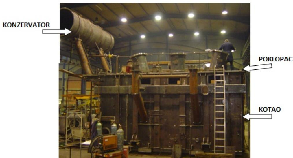
Slika 4.1 Glavni dijelovi trafokotla
