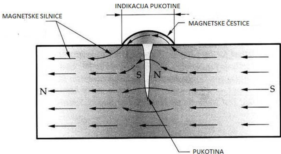
Slika 3.13 Princip rada metode ispitivanja magnetskim česticama
