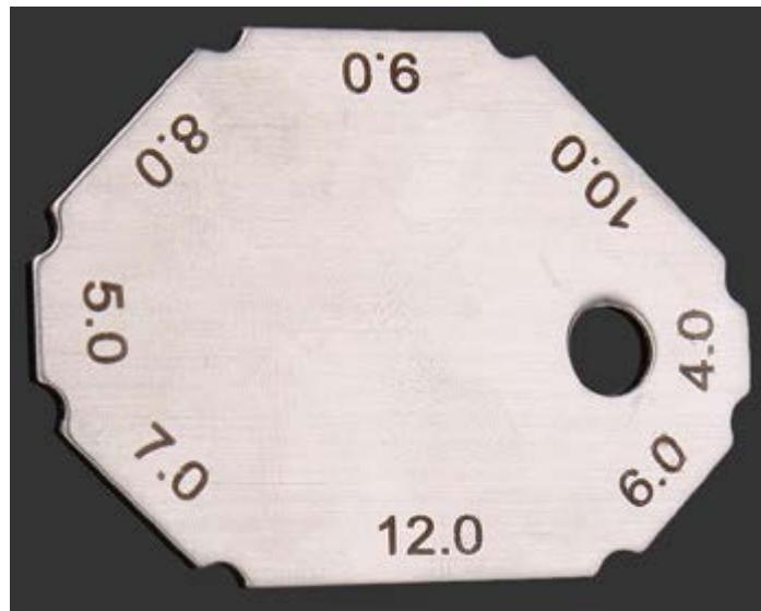
*Slika 3.2 Usporedno mjerilo za provjeru debljine kutnog zavarenog spoja [5]*
