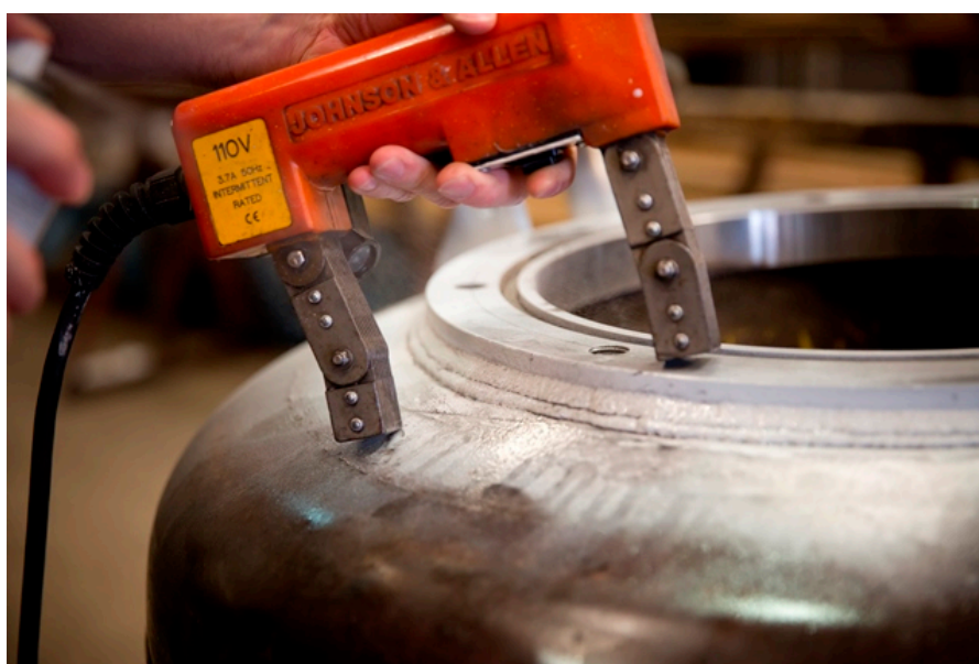
Slika 3.14. Primjer ispitne površine premazane kontrastnom bojom te tehnike magnetizacije pomoću magnetskog jarma
