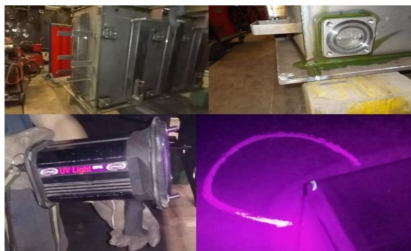
Slika 4.8 Ispitivanje zavarenih spojeva na nepropusnost fluorescentnim penetrantom
