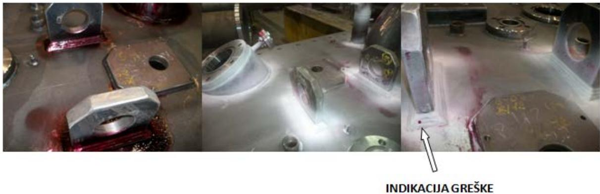
Slika 4.7 Ispitivanje zavarenih spojeva poklopca crvenim penetrantom
