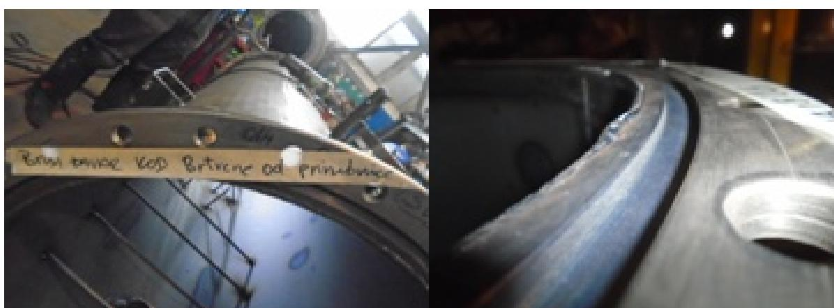
Slika 4.6. Primjer nedopuštenog izgleda zavara u dodiru sa brtvenom površinom
