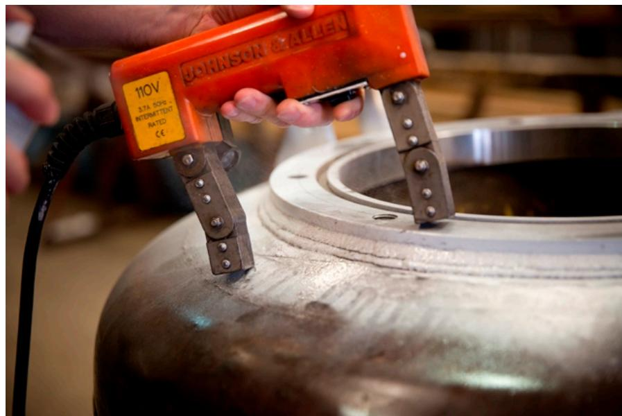
*Slika 3.14. Primjer ispitne površine premazane kontrastnom bojom te tehnike magnetizacije pomoći magnetskog jarma*
