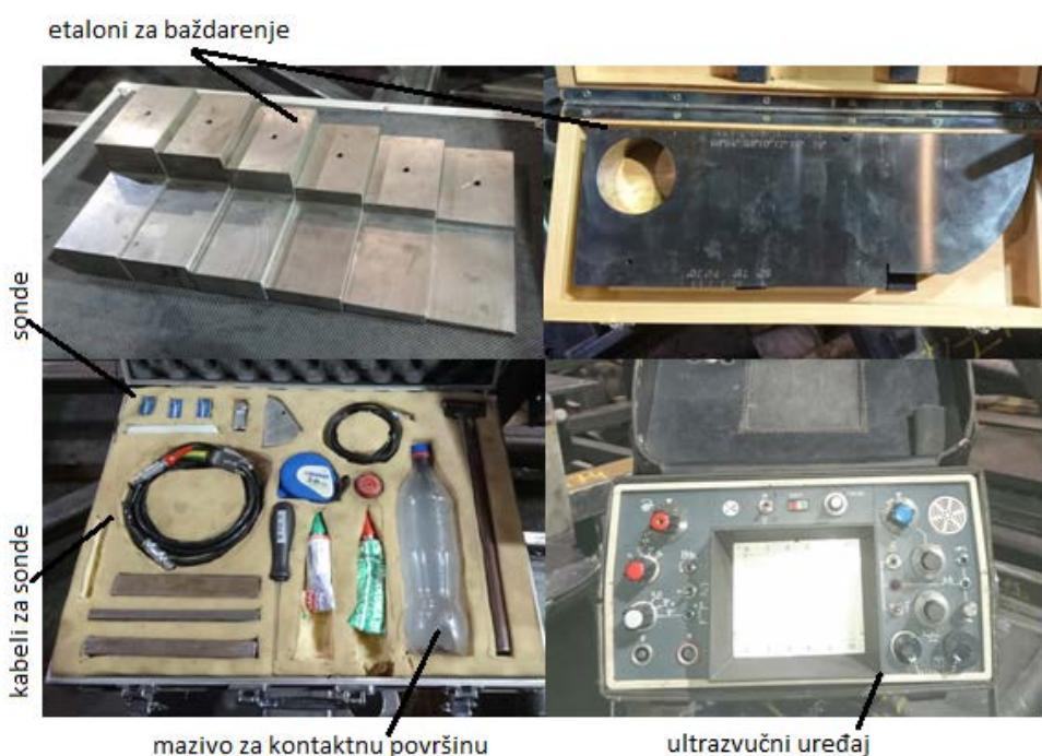
Slika 3.20 Oprema za ispitivanje ultrazvukom
