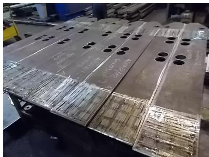
*Slika 4.10 Ispitivanje pozicije 2 na slojavost*
