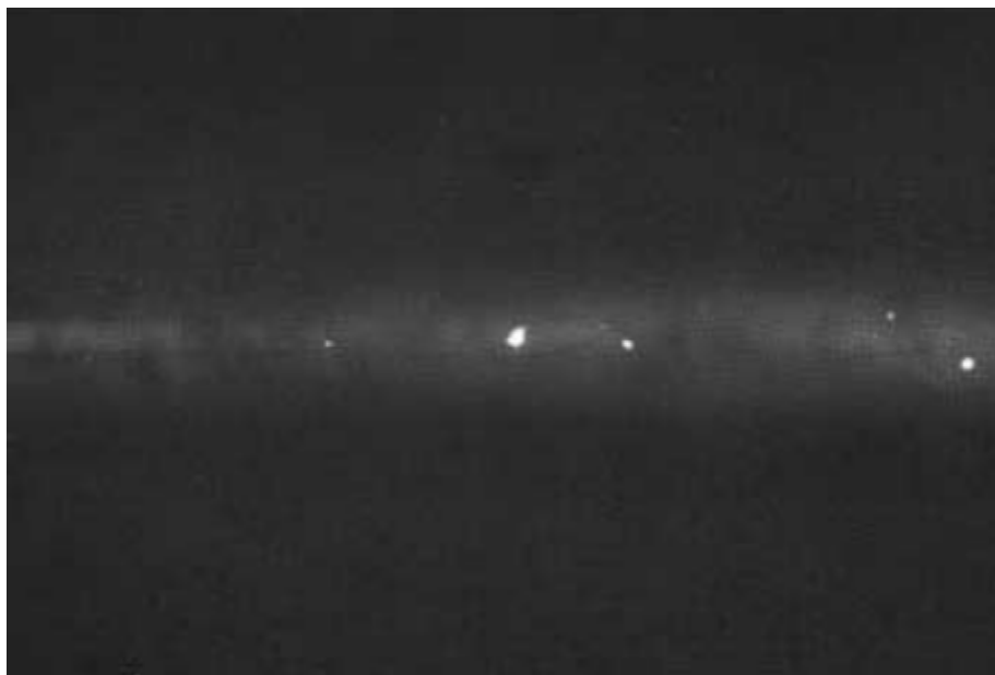
Slika 2.5 Uključci volframa (svijetle mrlje) vidljivi na radiogramu zavara [4]
