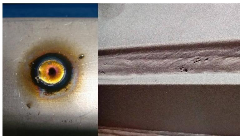
Slika 4.5 Neočišćeni ostaci prskanja (lijevo) i površinska poroznost zavara (desno)
