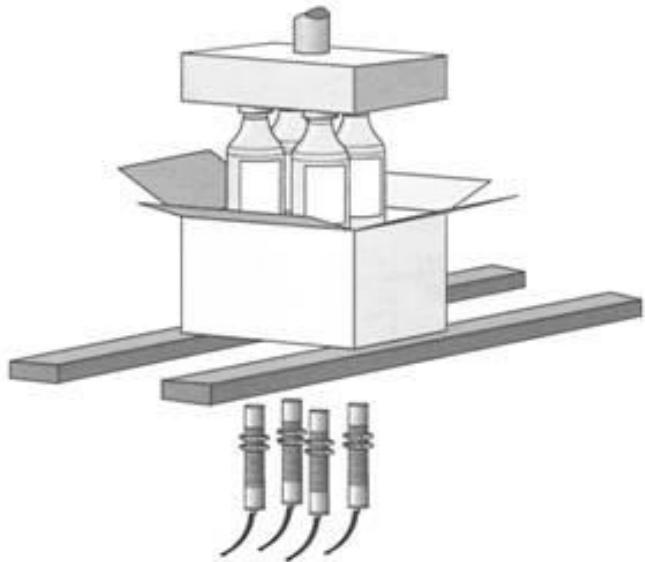
Slika 2.1 Kapacitivni senzori
