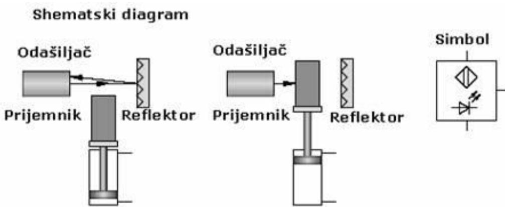
Slika 3.5 Optoelektronski senzor
