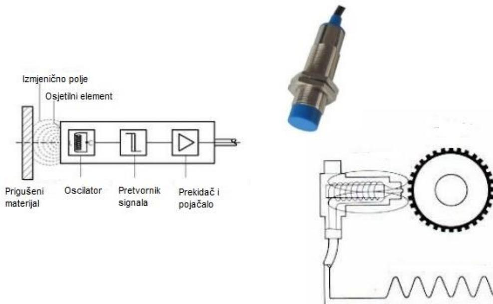
Slika 3.2 Induktivni senzor
