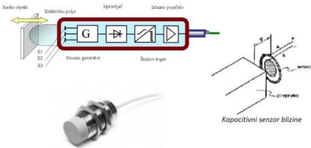
Slika 3.3 Kapacitivni senzor
