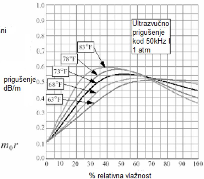
Slika 6.4 Maksimalan domet; slabljenje signala je oko 3 dB/ft (10 dB/m,  $l\text{ft}=0.3048\text{ m}$ ); za domet od 6 m intenzitet odašiljanog signala treba biti veći od 60 dB.; kutna preciznost; kretanje signala od ulaza do izlaza
