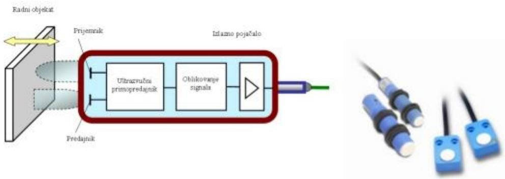
**Slika 3.4** Ultrazvučni senzor
