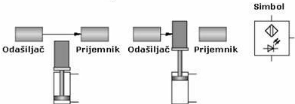
*Slika 2.3 Optički senzor*
