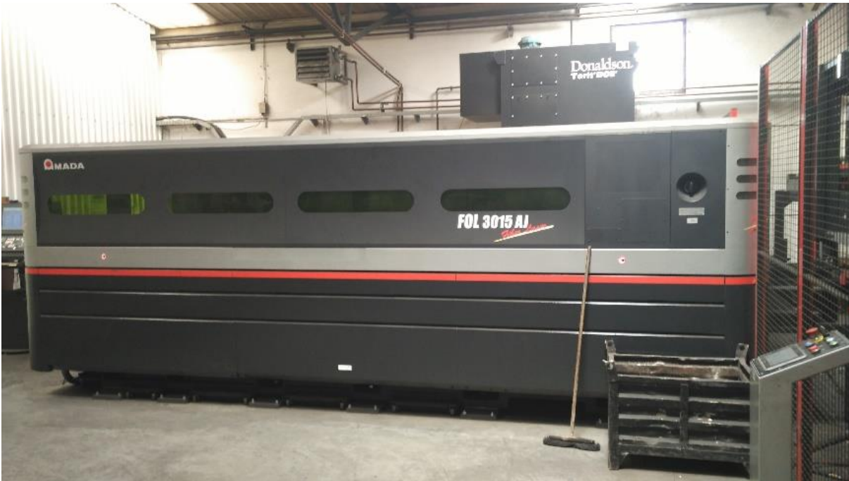
Slika 5.6 laser za rezanje podnice
