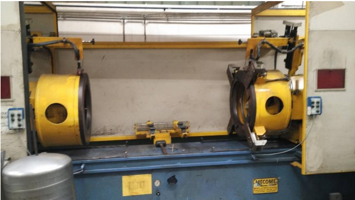
Slika 5.11 automatsko zavarivanje podnice s plaštom
