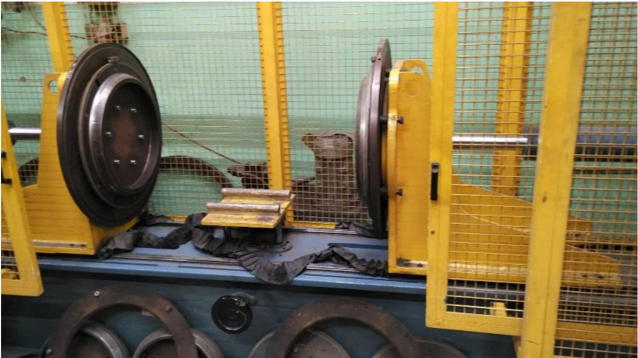
Slika 5.9 stroj za proširivanje rubova podnice
