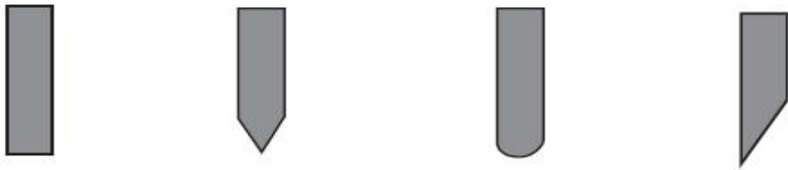
Slika 2.7. (S lijeva na desno) kvadratičasti, obostrano brušeni, zaobljeni i jednostrano brušeni rakel
