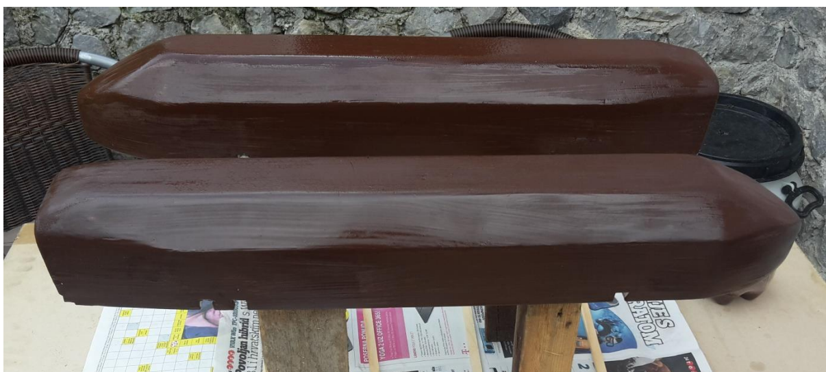
Slika 3.2 Trup modela čamca nakon premaza akrilnim emajl lakom
