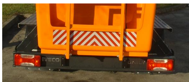
Slika 5.6: Pregled označenosti dijelova koji prelaze gabarite vozila
