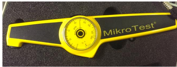
Slika 4.24: MikroTest – Uređaj za mjerenje debljine sloja boje
