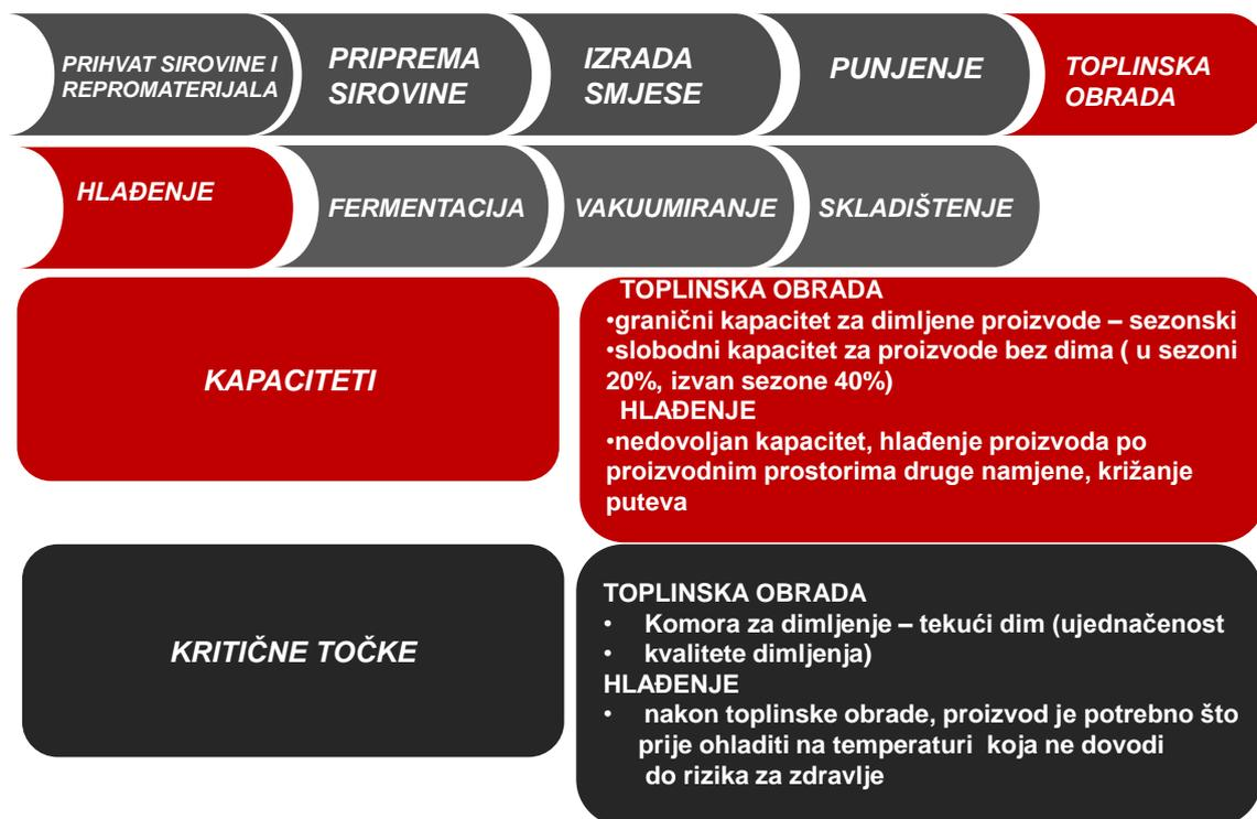
Slika 3.4 Opis proizvodnog procesa - toplinska obrada i hlađenje [7]
