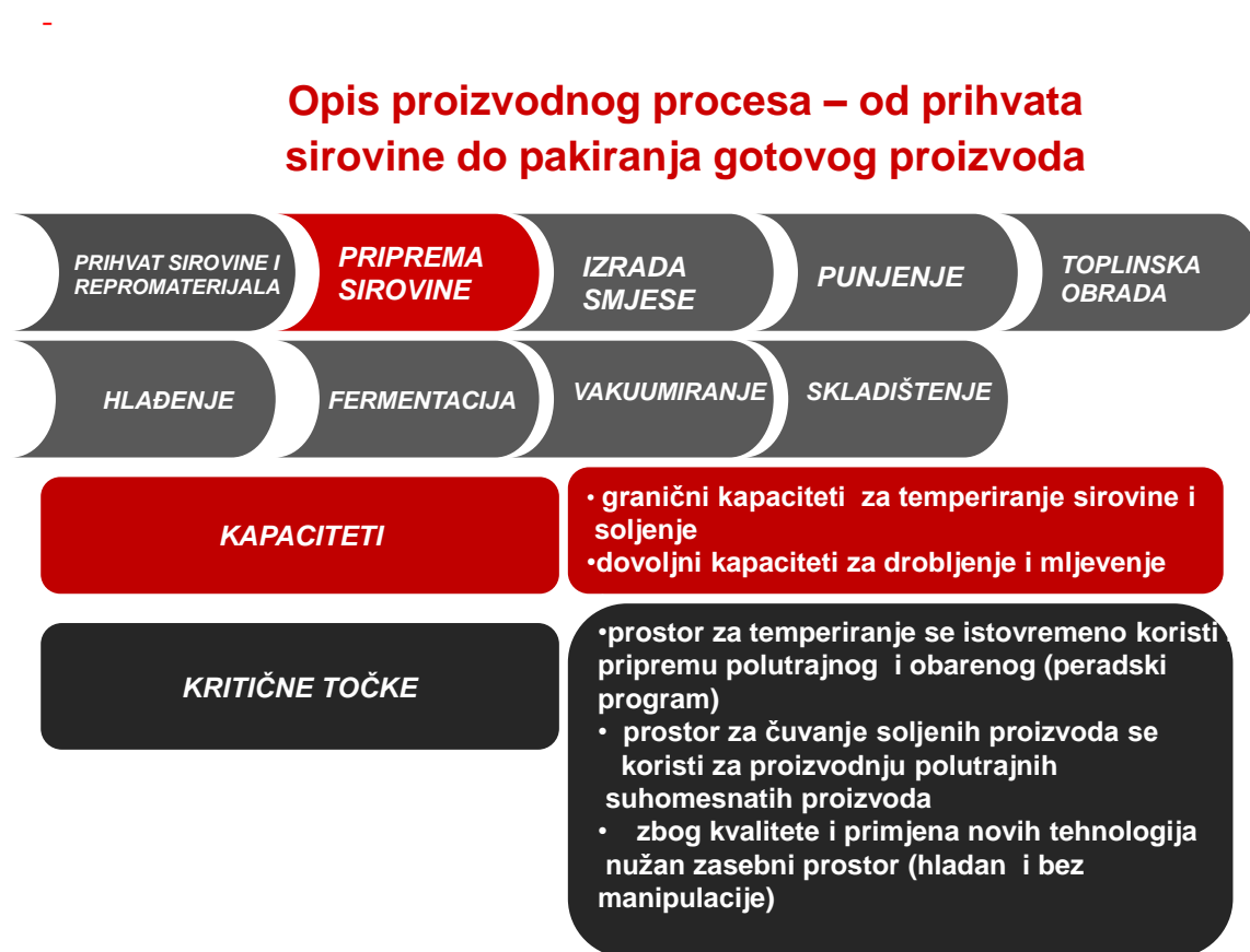
Slika 3.1 Opis proizvodnog procesa - priprema sirovine [7]
