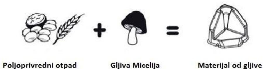
Slika 4.8 Postupak nastanka materijala od gljive
