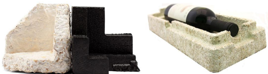
Slika 4.9 Materijal od gljive i primjer ambalaže
