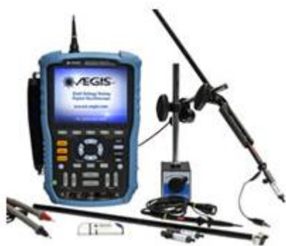
Slika 4.9 Digitalni osciloskop za mjerenje osovinskog napona američkog proizvođača [17]
