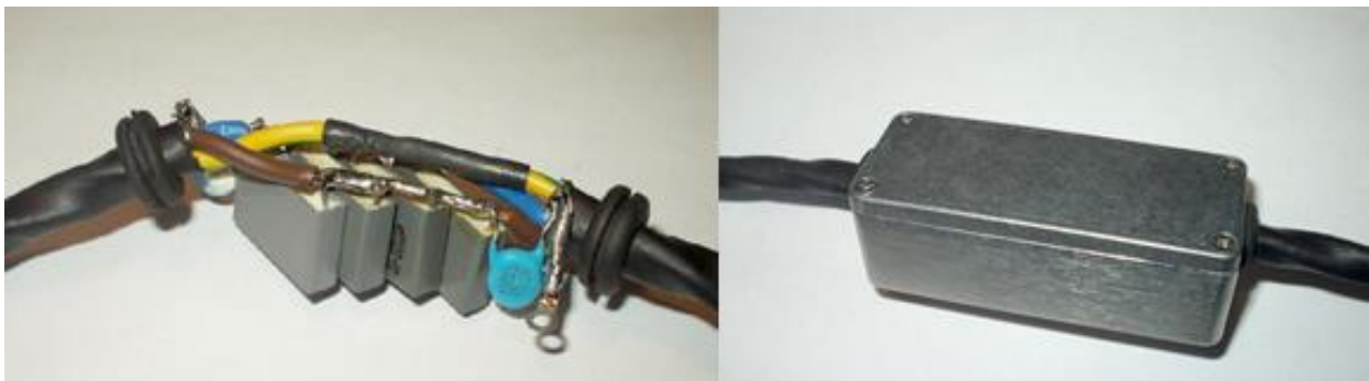
Slika 4.6 Paralelni mrežni filter MOX_MFP2 [16]
