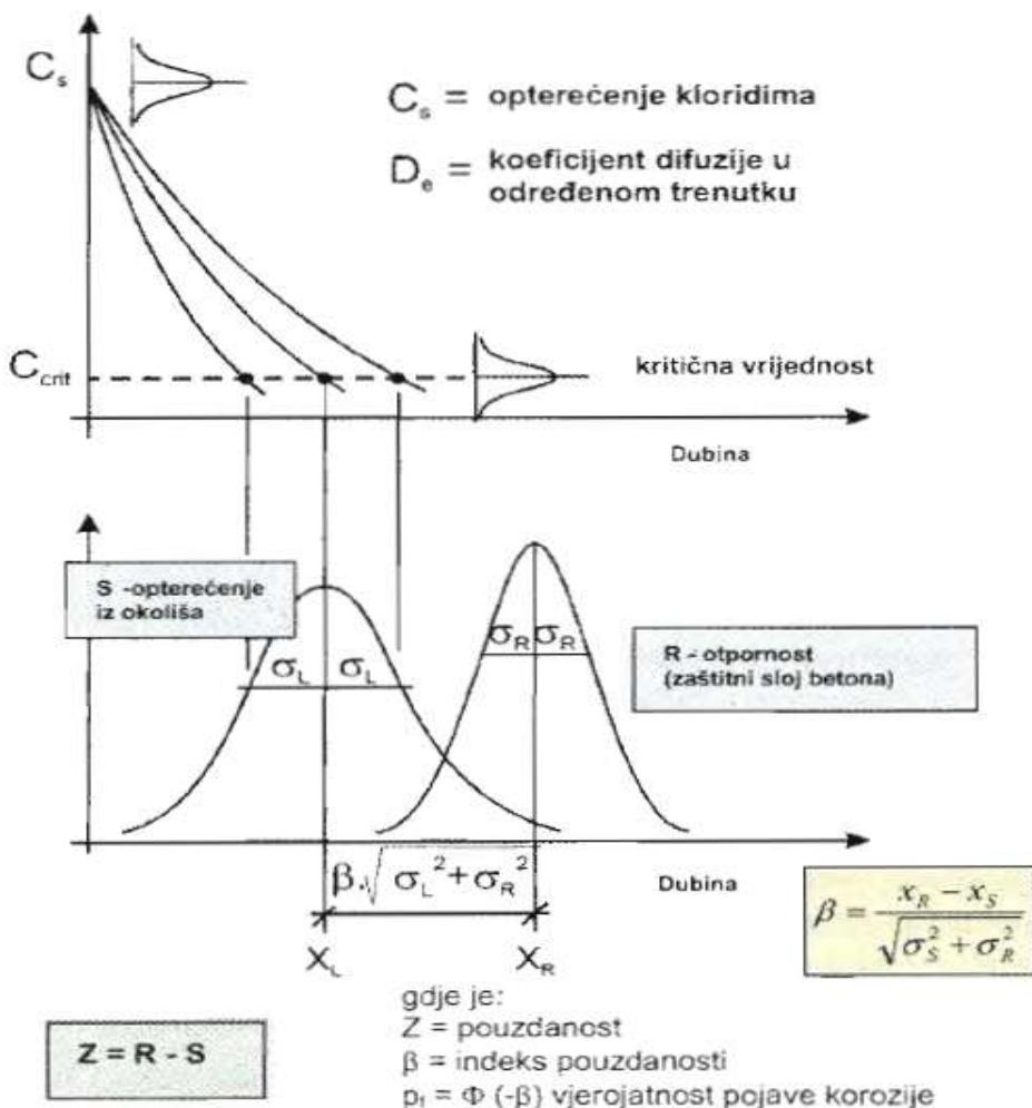
**Slika 16. 1.** Prikazuje jednostavan model za određivanje funkcije pouzdanosti  $Z$  u slučaju kad se armiranobetonska konstrukcija nalazi u morskom okolišu, odnosno kada je izložena djelovanju klorida
