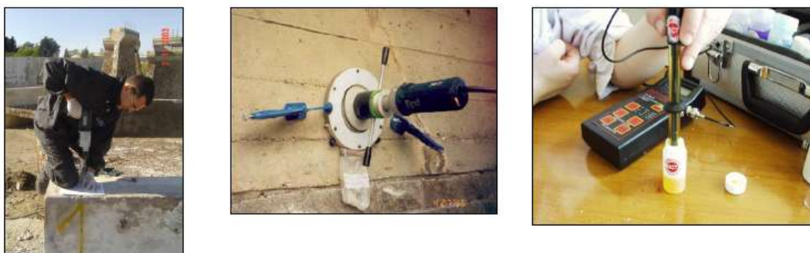
Slika 6.1. Postupak uzimanja praha betona za određivanja sadržaja klorida u betonu
