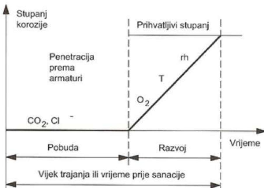
**Slika 4. 1.** Model Tuttyjevog razvoja korozije
