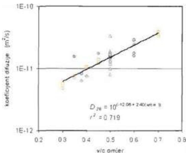
Slika 9.1. Ovisnost početnog koeficijenta difuzije D<sub>28</sub> i vodocementnog omjera na 20 °C
