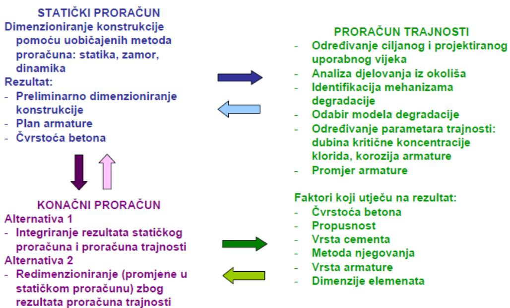
**Slika 3.3. Analogija dimenzioniranja nosivosti i trajnosti konstrukcije**
