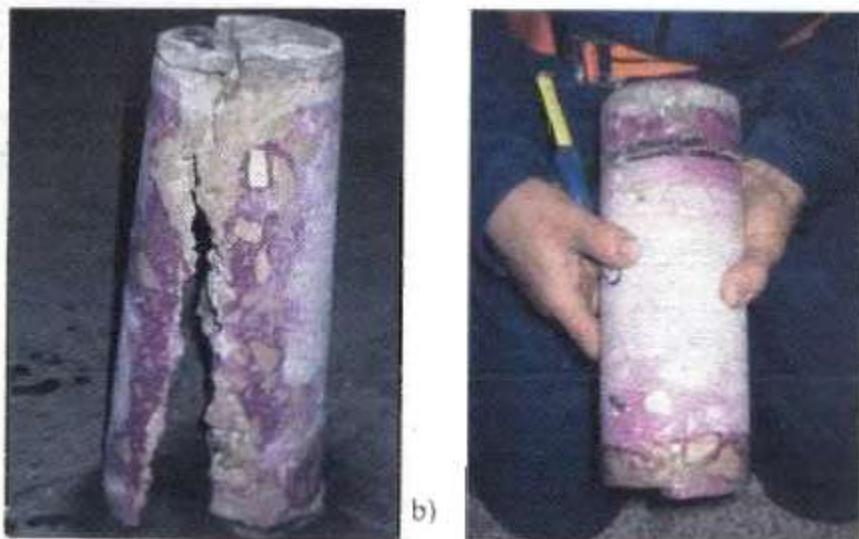
**Slika 17. 1.** a.) Uzorak betona potpuno ljubičast, pH niži od potrebnog b.) Uzorak gdje nije došlo u potpunosti do karbonatizacije
