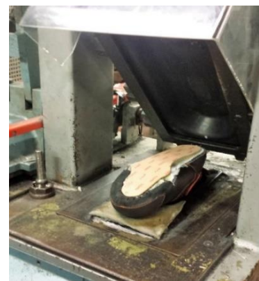
Slika 2.16. Prešanje temeljne tabanice
