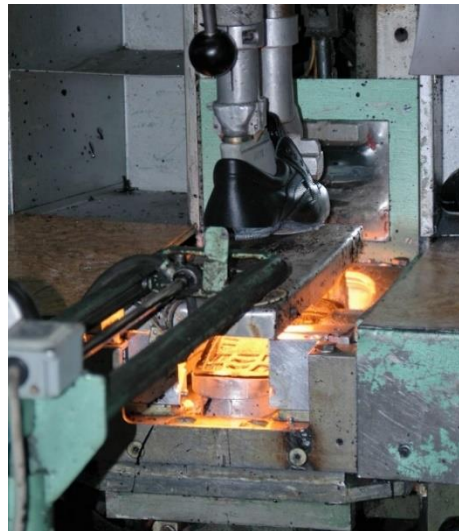
Slika 2.18. Navlačenje i centriranje gornjišta na formu
