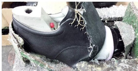
Slika 2.14. Potiskivanje zaštitne kapice
