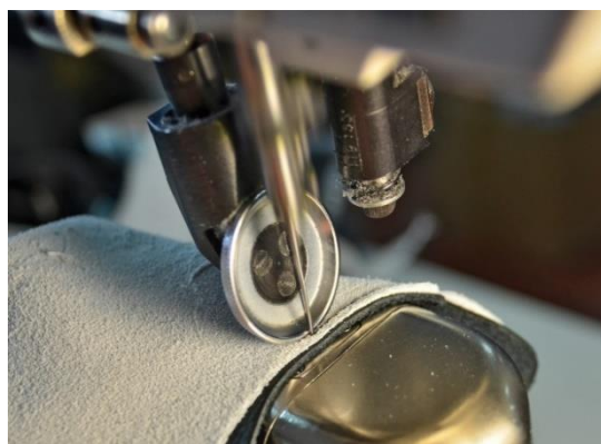
Slika 2.12. Šivanje podstave na lice
