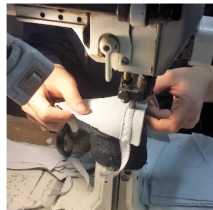
Slika 2.9. Šivanje antistatik trake
