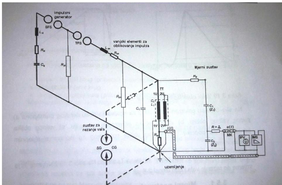
Slika 3.9.1. Mjerna shema za ispitivanje atmosferskim prenaponom [6]
