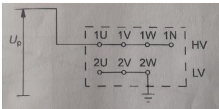
Slika 3.7.1. Spojna shema ispitivanja stranim naponom [6]
