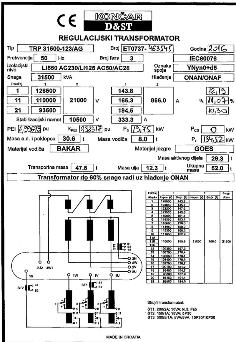
Slika 2.2.3.1 Natpisna pločica transformatora ispitivanog za ovaj završni rad [4]
