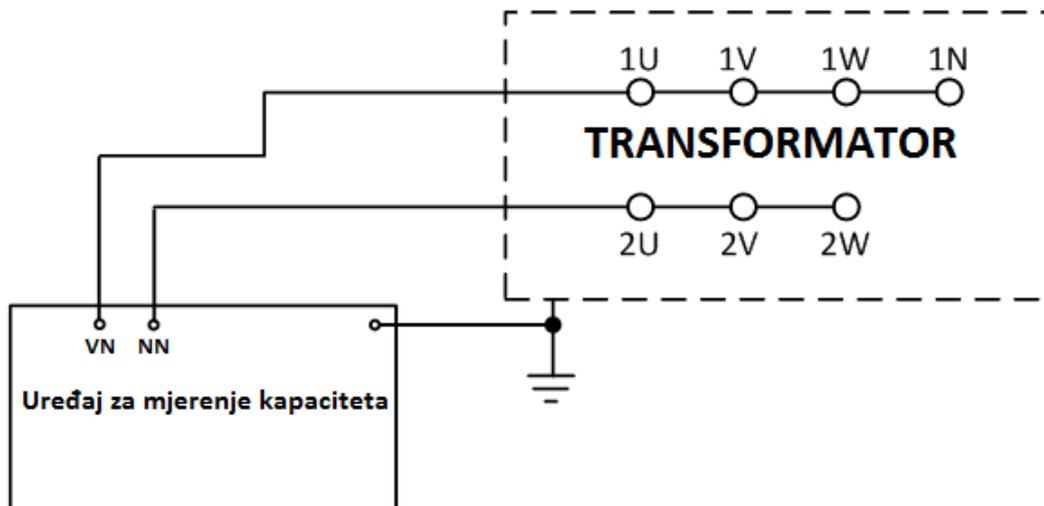
Slika 3.4.1. Spojna shema mjerenja kapaciteta i  $\tan\delta$  [7]
