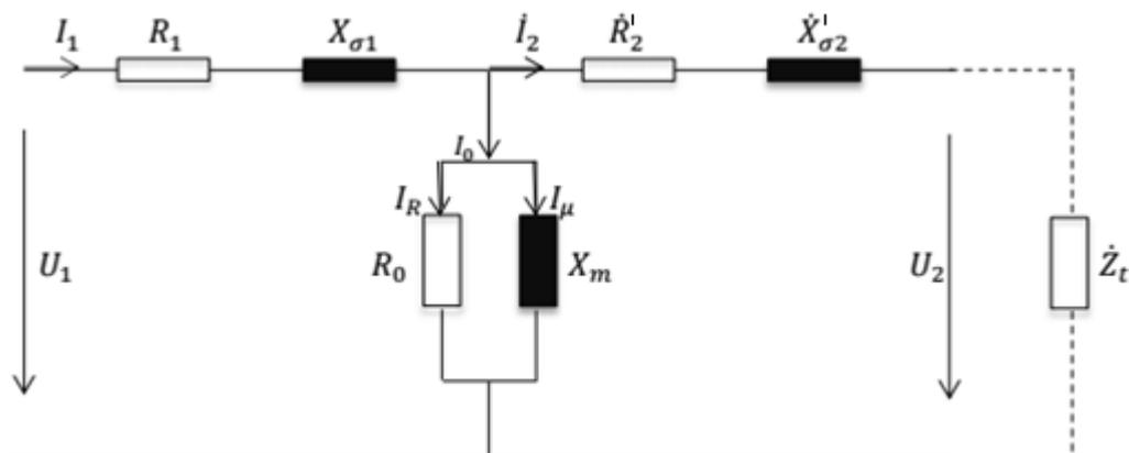
Slika 2.3.1. Nadomjesna shema transformatora s reduciranim sekundarnim veličinama [3]
