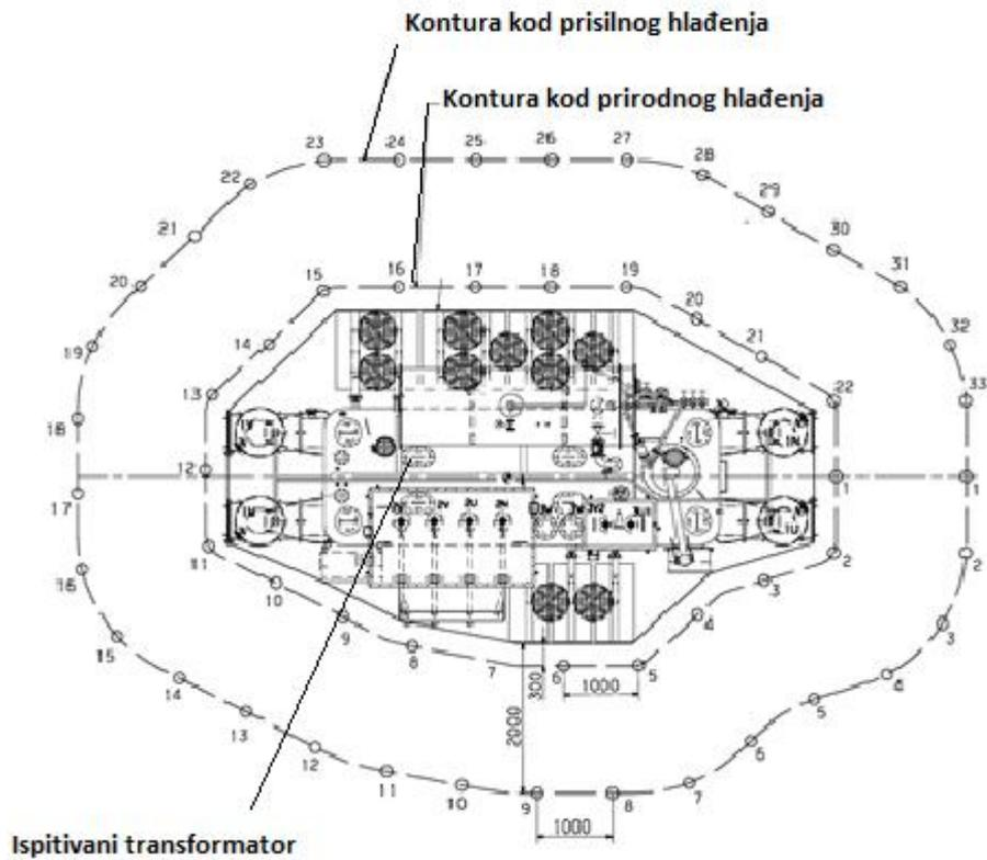
Slika 3.12.1. Kontura mjerenja buke sa mjernim točkama [7]
