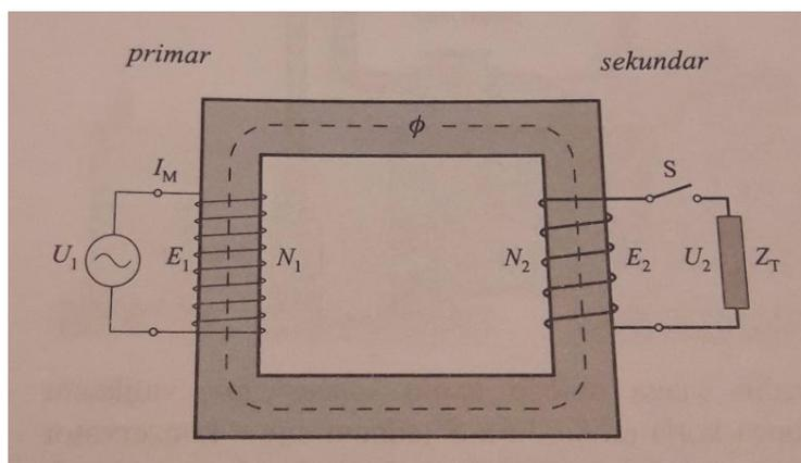
Slika 2.1.1. Načelna shema jednofaznog dvonamotnog transformatora [1]
