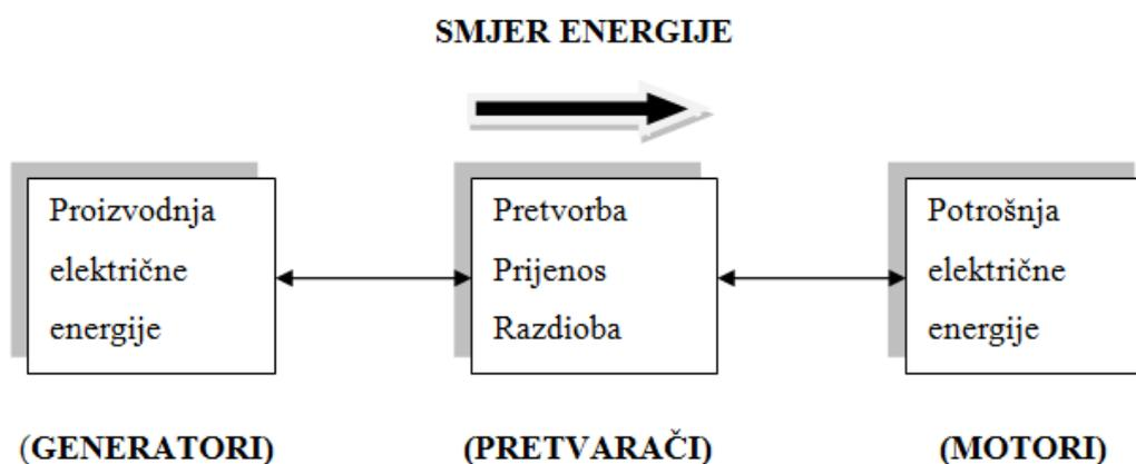
*Slika 1.1.1. Pojednostavljena blok shema elektroenergetskog sustava [1]*
