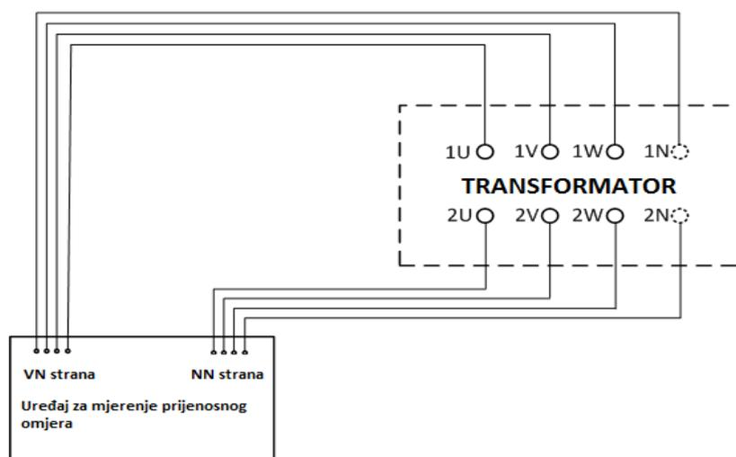
Slika 3.1.1. Spojna shema mjerenja prijenosnih omjera [7]
