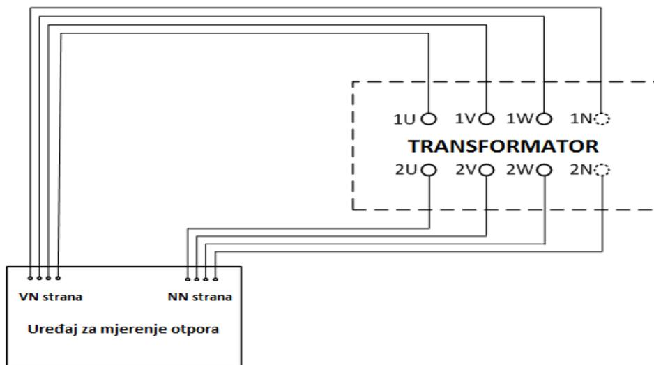
Slika 3.2.1. Spojna shema mjerenja otpora [7]
