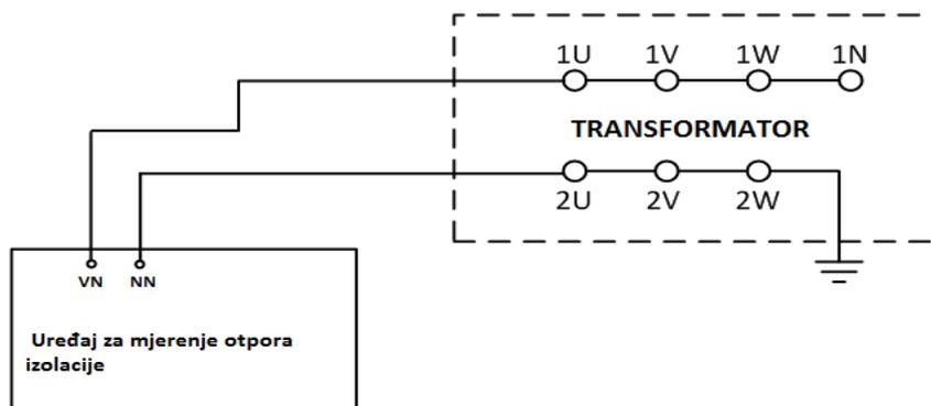
Slika 3.3.1. Spojna shema mjerenja otpora izolacije [7]
