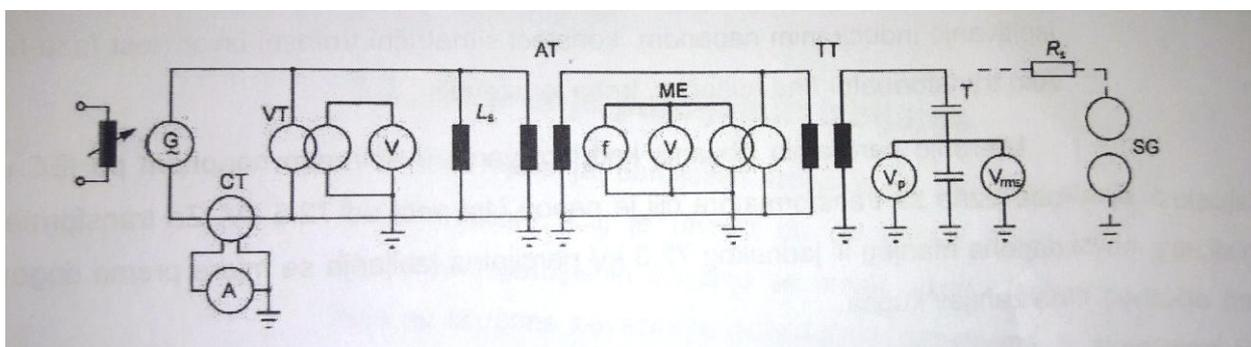
Slika 3.6.1. Mjerni krug za ispitivanje induciranim naponom [6]
