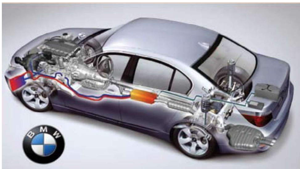
Slika 2.10 Termogenerator ugrađen na ispušni sustav [10]
