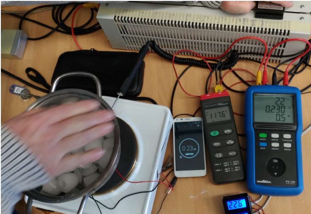
Slika 3.11 Tijek pokusa generiranja napona i struje
