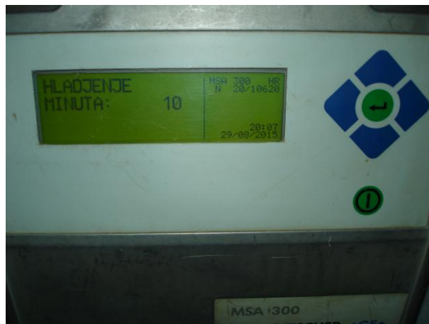
Slika 4.4. Ponovljeno zavarivanje uzorka br. 2. - prikaz podataka na zaslonu aparata za vrijeme hlađenja [13]
