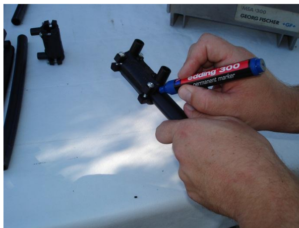
Slika 3.9. Priprema uzoraka za zavarivanje a) usađivanje cijevi u elektrokapu b) usađivanje cijevi u elektrospojnicu i označavanje flomasterom [13]
