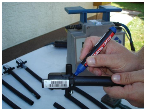
Slika 3.9. Priprema uzoraka za zavarivanje a) usađivanje cijevi u elektrokapu b) usađivanje cijevi u elektrospojnicu i označavanje flomasterom [13]
