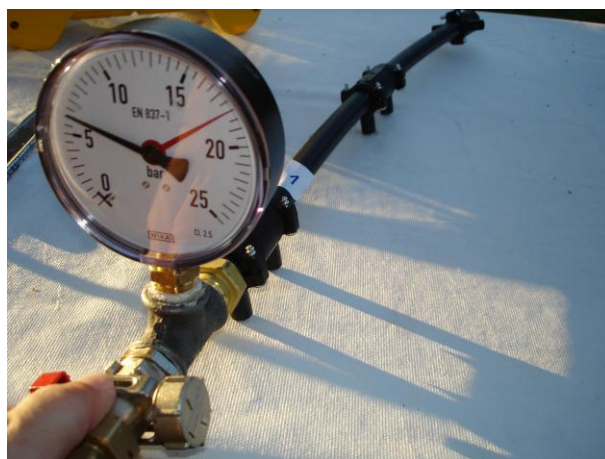
Slika 3.32. Tlačanje uzorka br. 1 na tlak od 6 bara [16]
