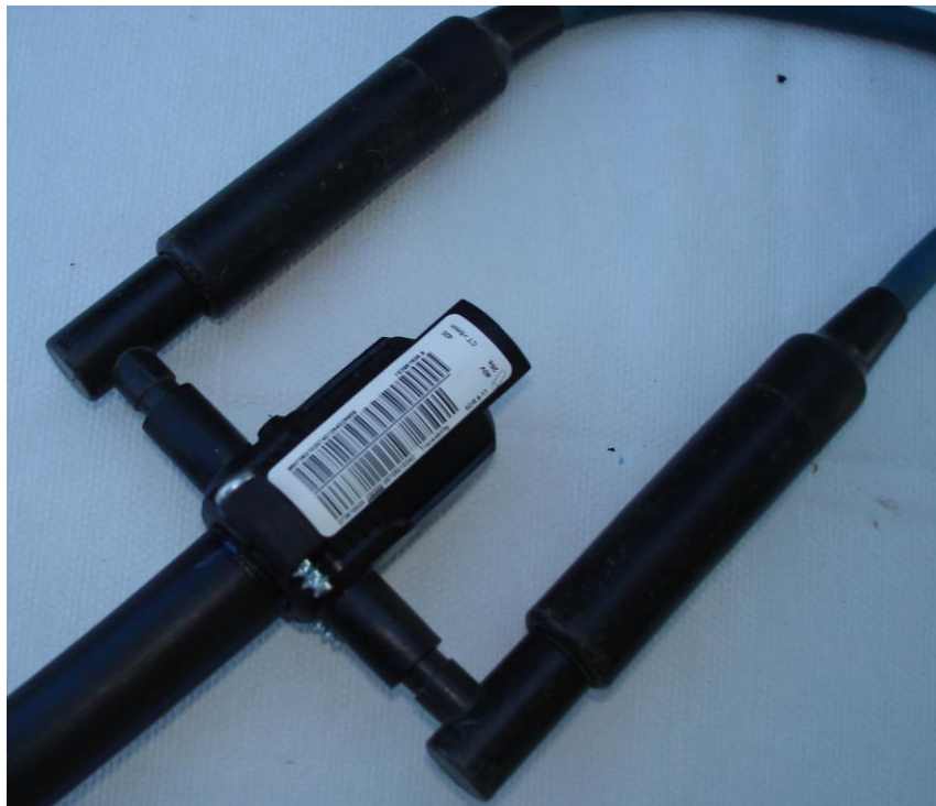
Slika 3.17. Kablovi za zavarivanje sa adapterima za priključak na elektrofiting [13]
