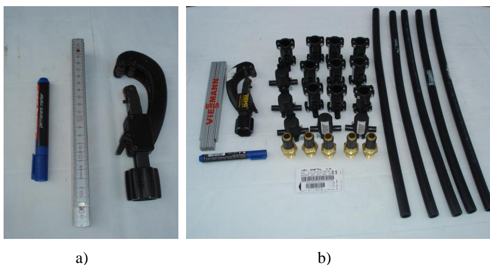
Slika 3.5. Alat i pribor kod rezanje cijevi a) alat i pribor kod rezanja cijevi b) alat, pribor i pripremljeni izrezani uzorci sa spojnim komadima [13]
