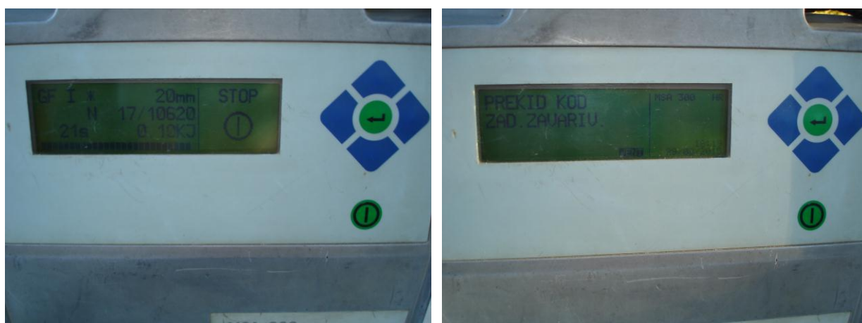
Slika 3.26. Prikaz podataka na zaslonu aparata a) za vrijeme zavarivanja b) nakon ponovnog uključanja [13]
