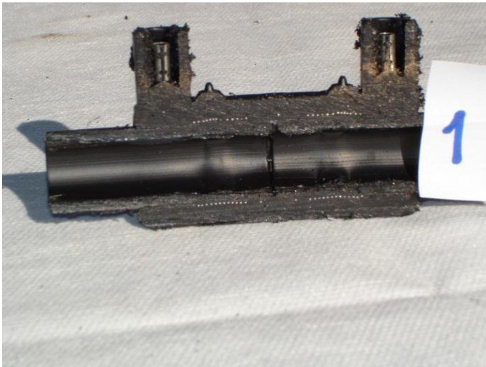
Slika 4.1. Presjek cijevi i elektrospojnice kod uzorka br.1 [13]
