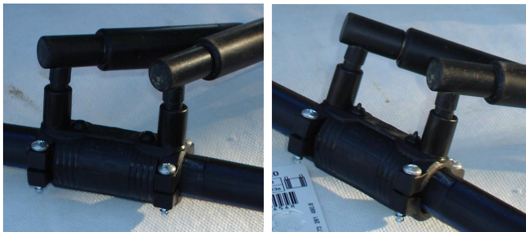
Slika 3.22. Indikator zavarivanja na elektrofitingu a) prije, b) poslije zavarivanja [13]
