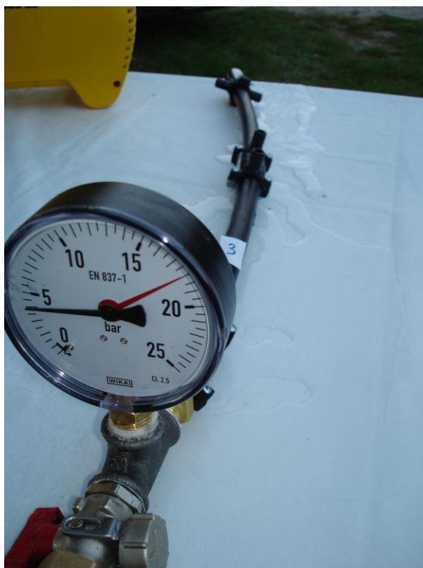
Slika 3.35. Tlačno ispitivanje uzorka br. 3 - prikaz tlaka kod kojeg dolazi do propuštanja zavarenog spoja [13]
