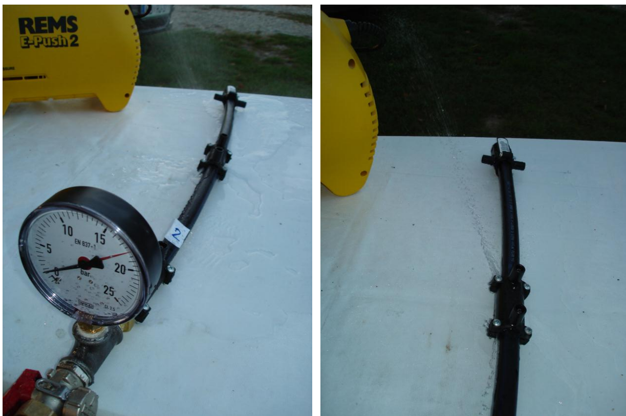
Slika 3.34. Tlačno ispitivanje uzorka br. 2 a) prikaz tlaka kod kojeg dolazi do propuštanja spoja b) istjecanje vode na zavarenom spoju [13]
