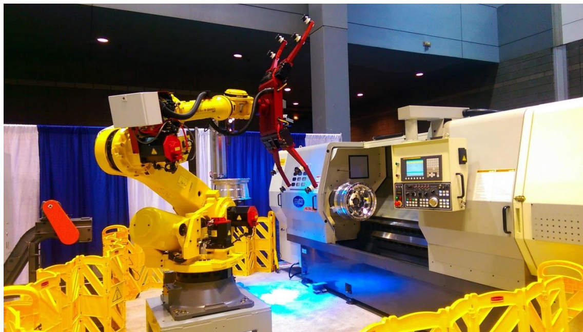
Slika 7.16. Robot poslužuje CNC tokarilicu [14]
