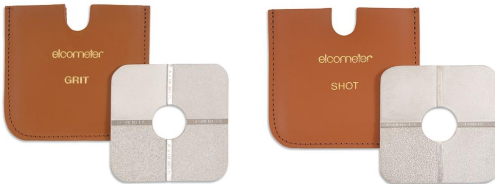
Slika 7.1.1 Komparatori: lijevo "Grit" komparator, desno "Shot" komparator [5]
