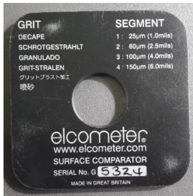
Slika 8.1.3 Vrijednosti pojedinih segmenata komparatora (Grit sačma)
