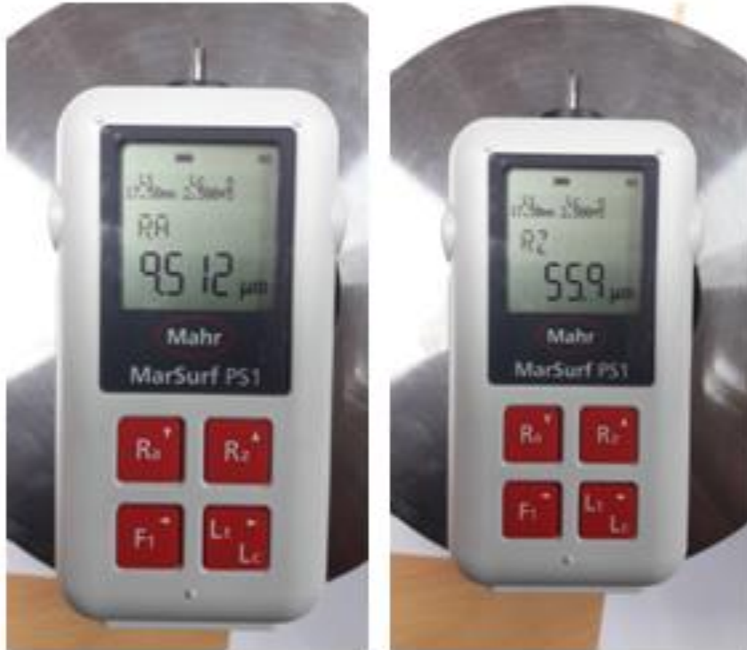
Slika 8.2.4 Rezultati mjerenja hrapavosti – hrapavost izvan dopuštenih granica
