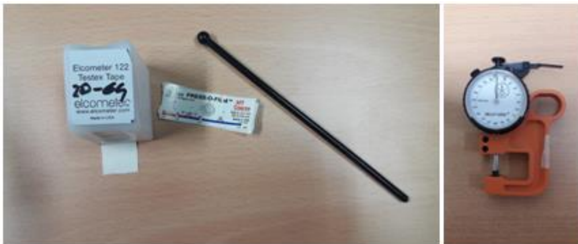
Slika 8.1.4 Oprema za mjerenje replika trakom
