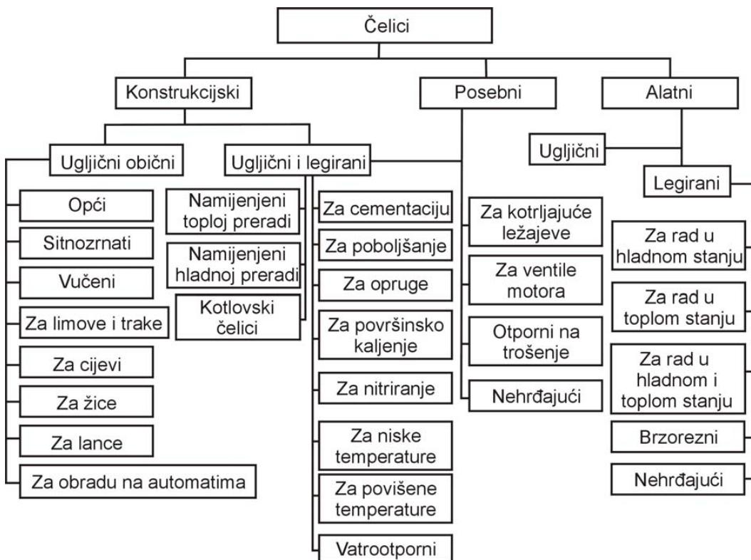
Shema 1.2 Opća podjela čelika prema namjeni [5]
