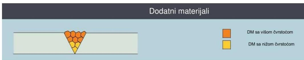
Slika 4.16 Korištenje različitih DM pri zavarivanju Strenx čelika [18]
