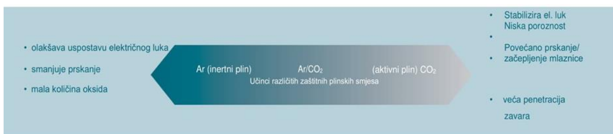
Slika 4.17 Učinci odabranog zaštitnog plina pri zavarivanju [18]
