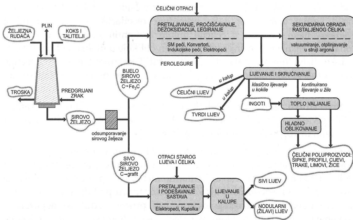
Shema 1.1 Dobivanje čelika i željeznih ljevova [1]
