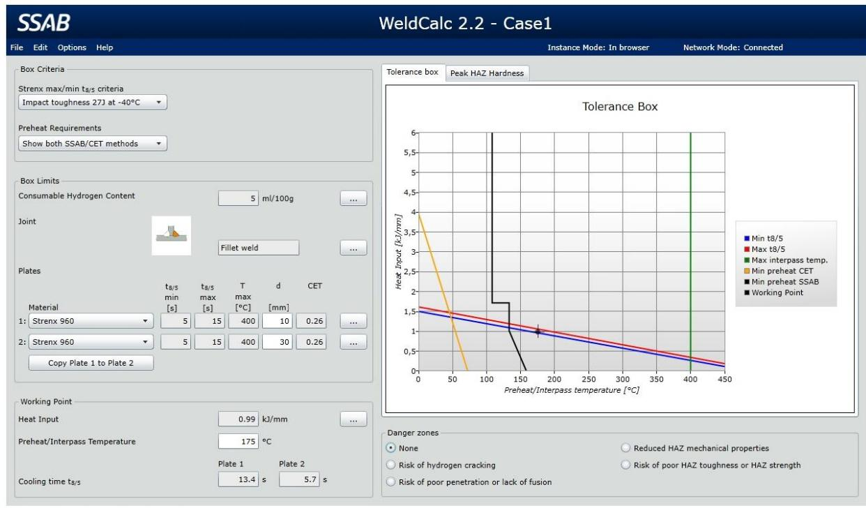
*Slika 5.4 Aplikacija WeldCalc za proračun parametara zavarivanja [26]*
