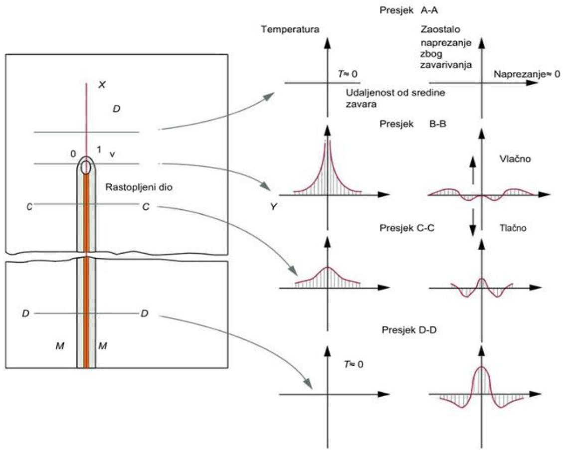
Slika 4.6 Nastanak i smjer zaostalih naprezanja u zavarenom spoju [19]
