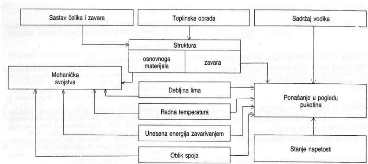
Slika 4.3 Shema utjecaja na zavarljivost čelika [21]
