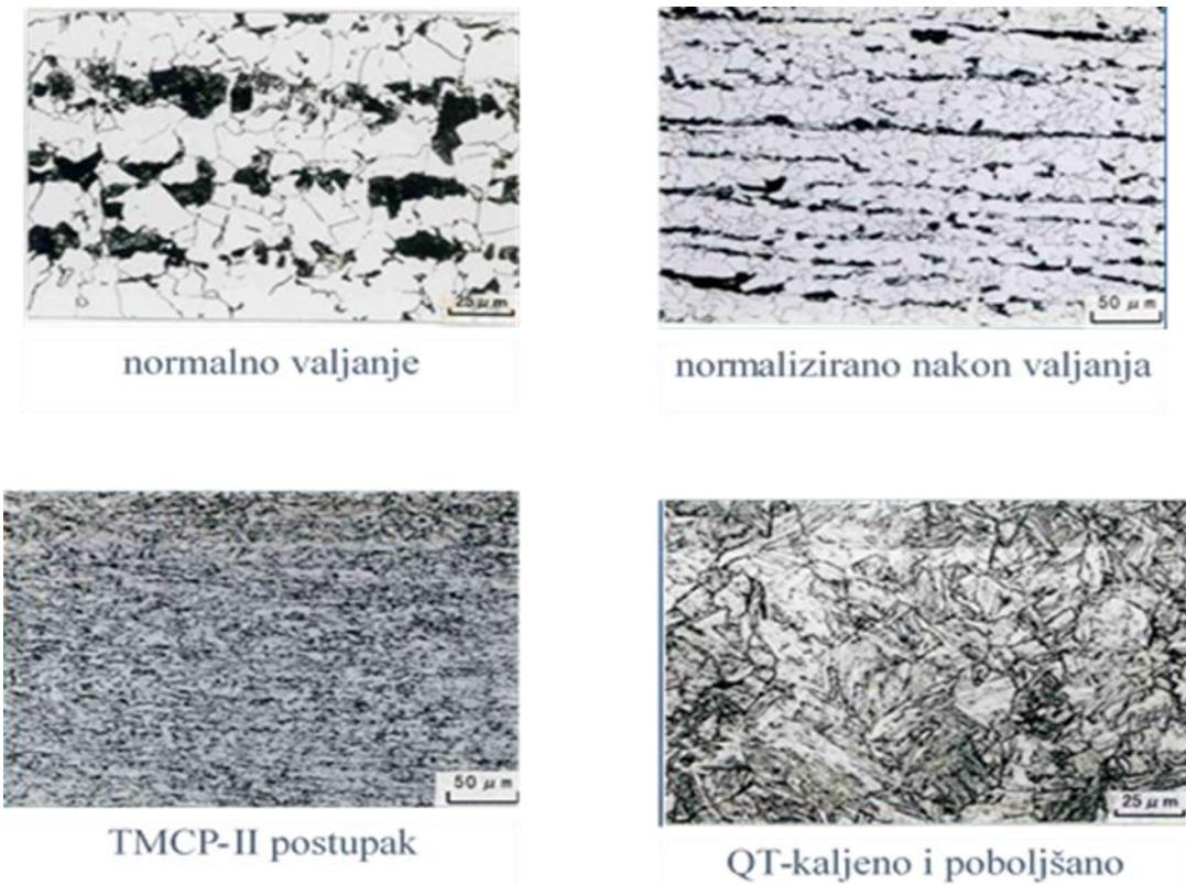
slika 2.2 Mikrostrukture toplovaljanih čelika dobivenih različitim postupcima [24]
