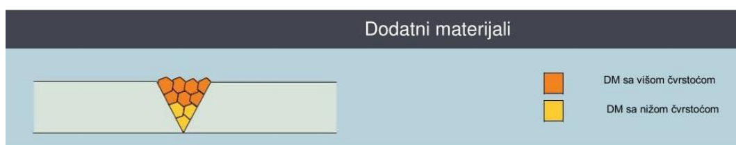
Slika 4.16 Korištenje različitih DM pri zavarivanju Strenx čelika [18]
