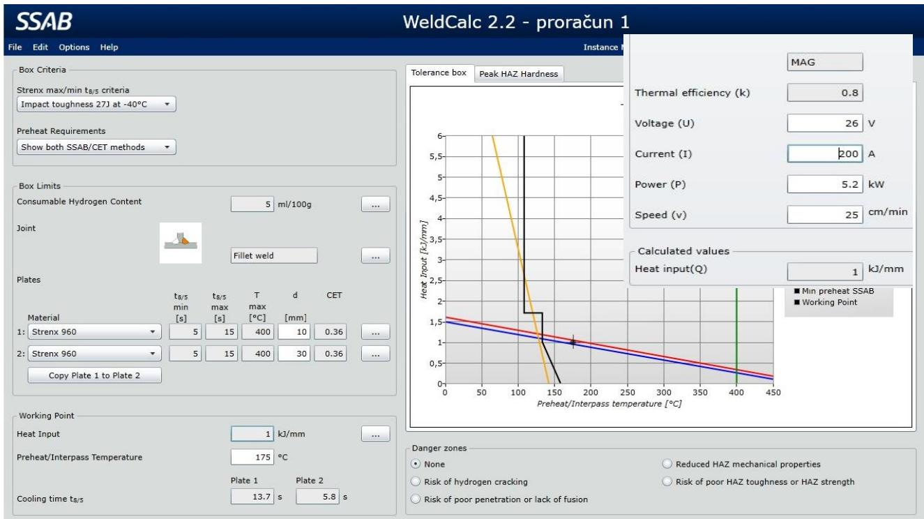
Slika 5.8 Konačni izračun parametara zavarivanja za prvi prolaz [26]
