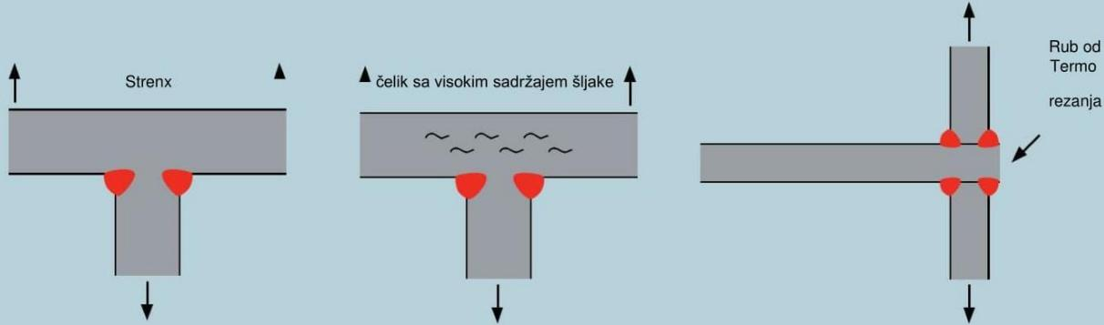
Lamenarno odvajanje. Razlika između Strenx čelika i čelika sa visokim udjelom šljake
