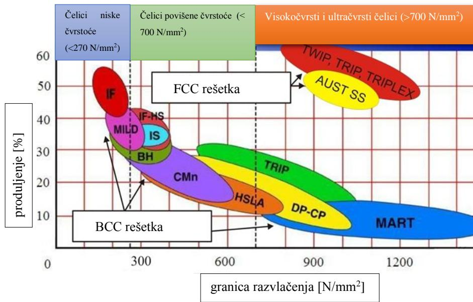
Slika 2.1 Vrste čelika i odnos čvrstoće i istezljivosti [27]
