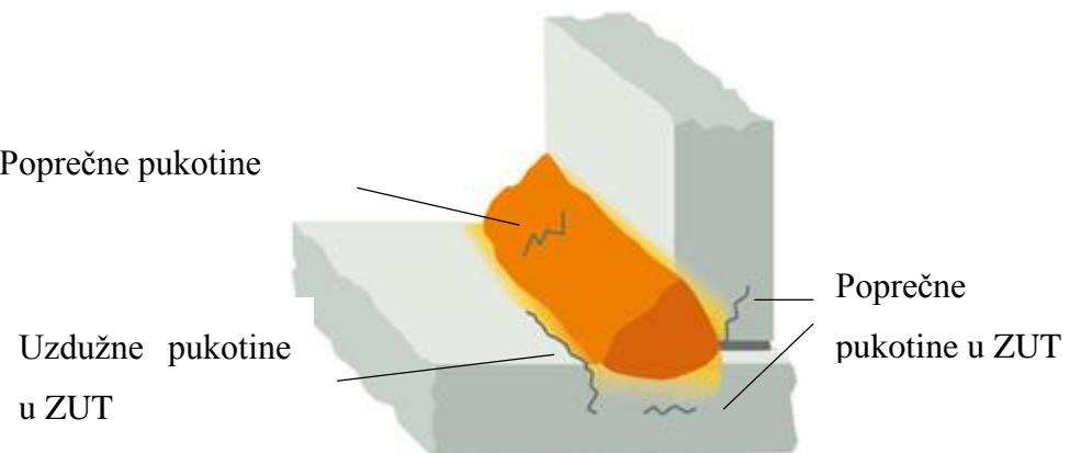
Slika 4.5 Položaj i orientacija hladnih pukotina u zavarenom spoju [19]
