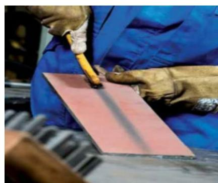
Slika 4.2 Skidanje zaštitnog sloja sa Strenx čelika [19]
