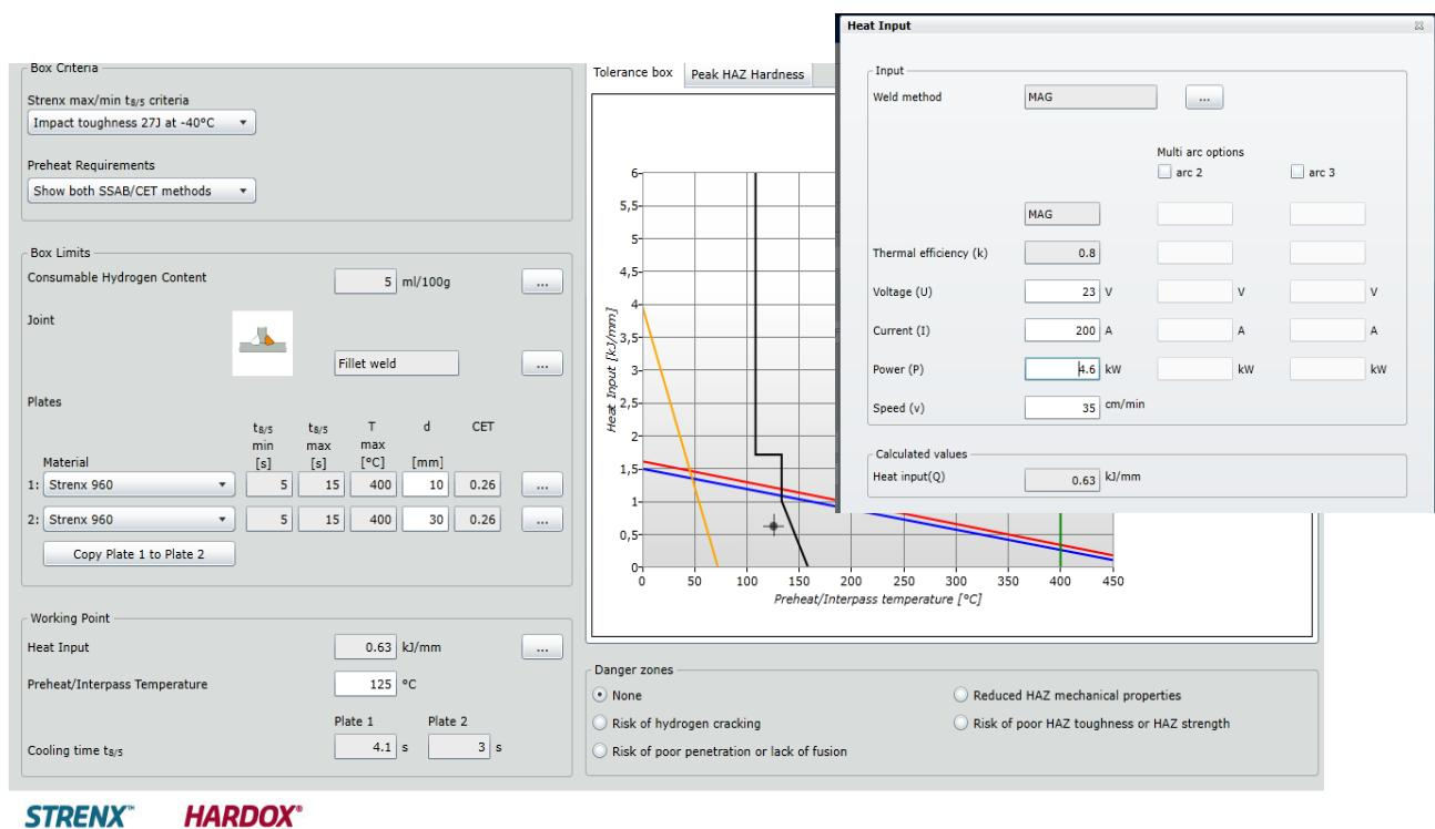
Slika 5.7 Promjenom parametara narušena kvaliteta zavara (crna točka) [26]
