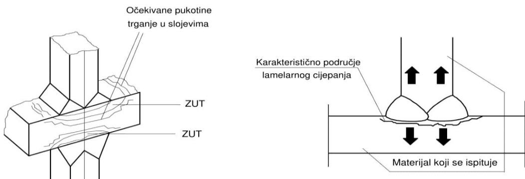
Slika 4.14 Područja zavarenog spoja gdje se pojavljuje lamelarno (slojevito) trganje [11]
