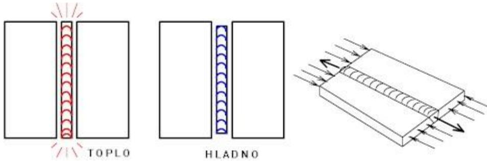
Slika 4.9 Pojava zaostalih naprezanja zbog nejednolikog rastezanja [11]
