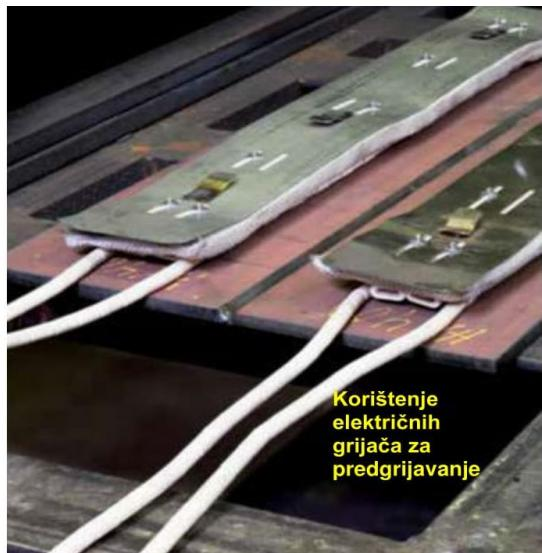
Slika 4.10 Predgrijavanje Strenx čelika električnim oblogama [18]
