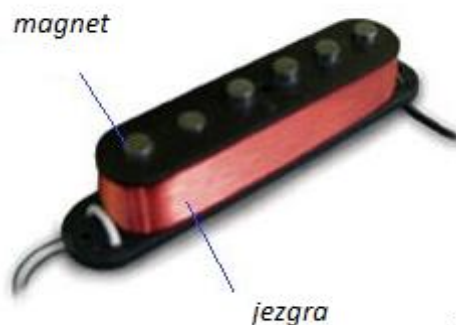
Slika 2.2. Izgled magneta gitare, engl. "Pickup"[3]
