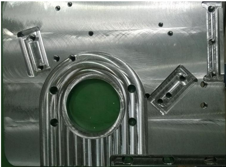
Slika 8.10 Obrađena prva strana ploče
