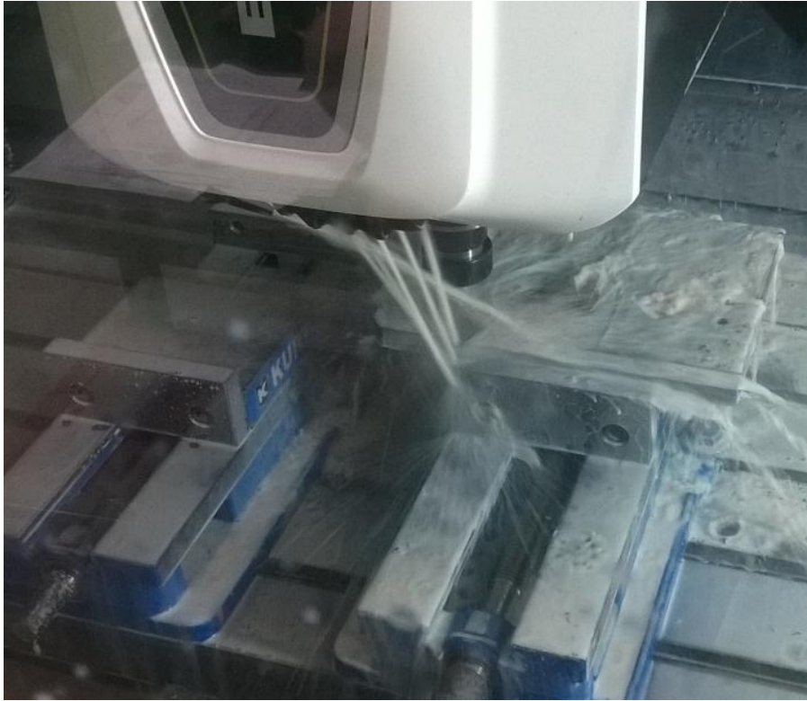
Slika 8.9 Izrada gornje strane pozicije na stroju
