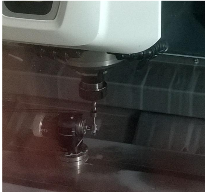
Slika 8.8 Automatsko umjeravanje alata
