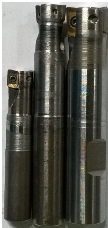
Slika 6.18 Glodala sa pločicama \text{Ø}10 mm, \text{Ø}12 mm i \text{Ø}16 mm
