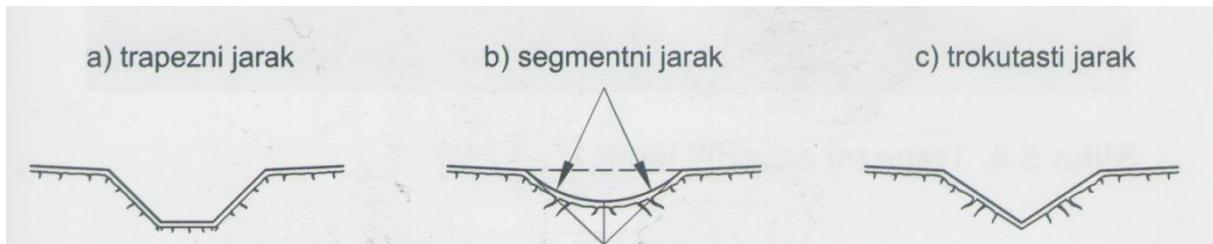
*Slika 1. Poprečni presjeci jarka*
