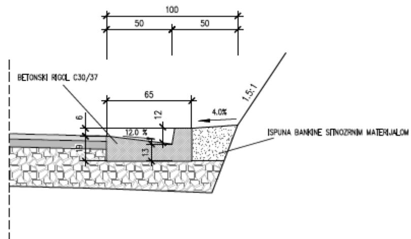
*Slika 16. Betonski rigol*
