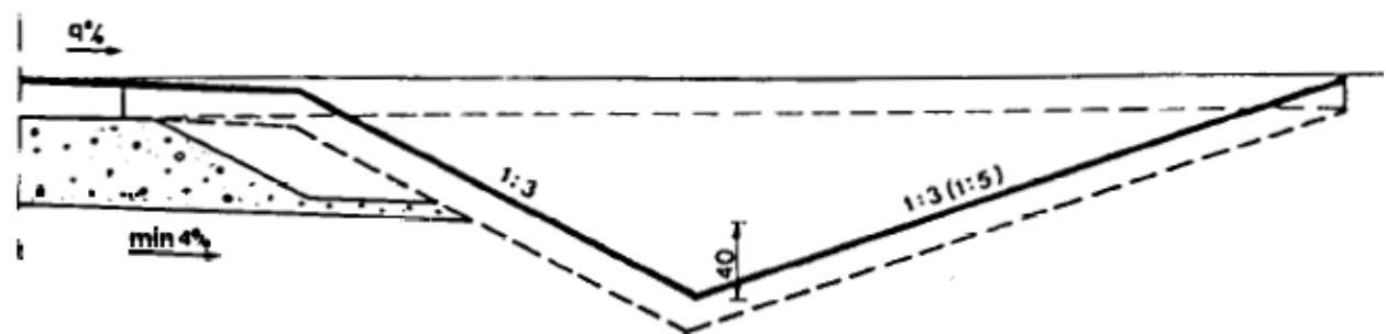
*Slika 4. Trokutasti odvodni jarak*
