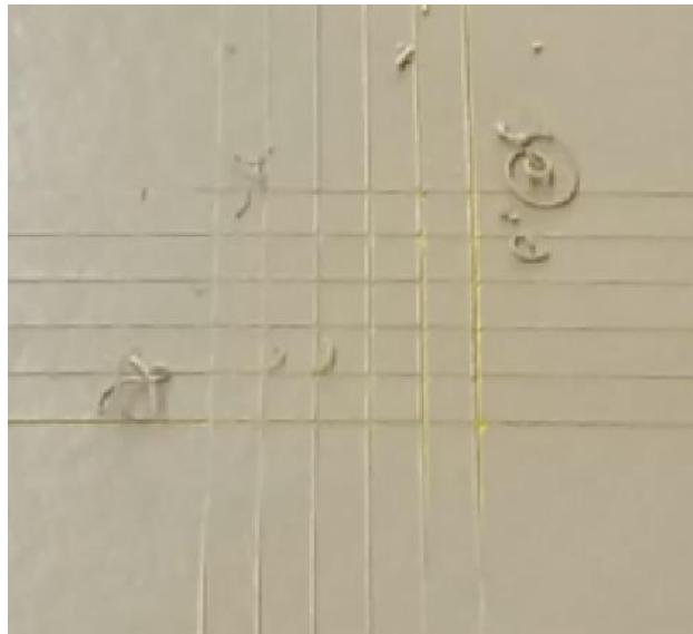
Slika 33. Izgled mrežice neposredno nakon zarezivanja na šasiji MV-10
