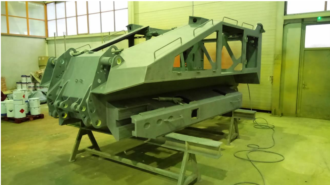
Slika 12. Šasija stroja za razminiranje MV-10 nakon pjeskarenja
