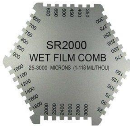
Slika 10. Šesterokutni češalj za mjerenje mokrog filma premaza [14]
