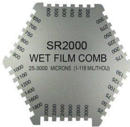
Slika 10. Šesterokutni češalj za mjerenje mokrog filma premaza [14]
