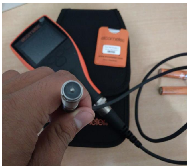
Slika 23. Uređaj za mjerenje debljine suhog filma premaza Elcometer 456
