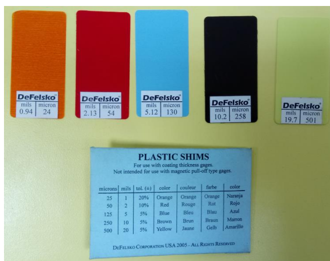
Slika 24. Etalonski listići za kalibriranje uređaja Elcometer 456
