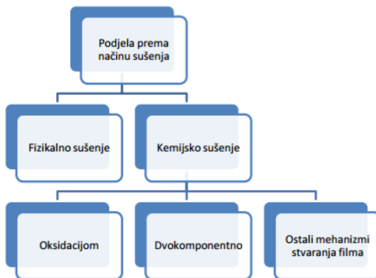
Slika 3. Podjela premaza prema načinu sušenja [5]
