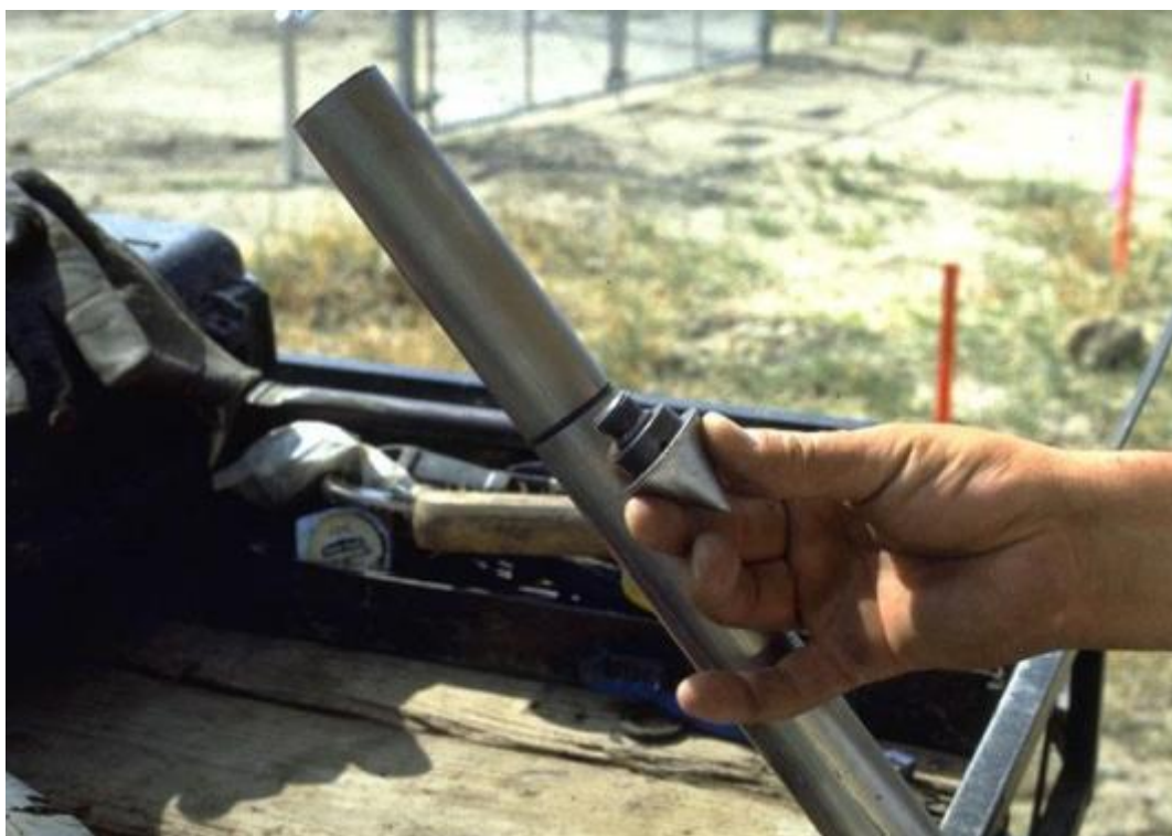
Slika 2.4. Sprave za izvođenje CPT-a (sonda i šiljak)
