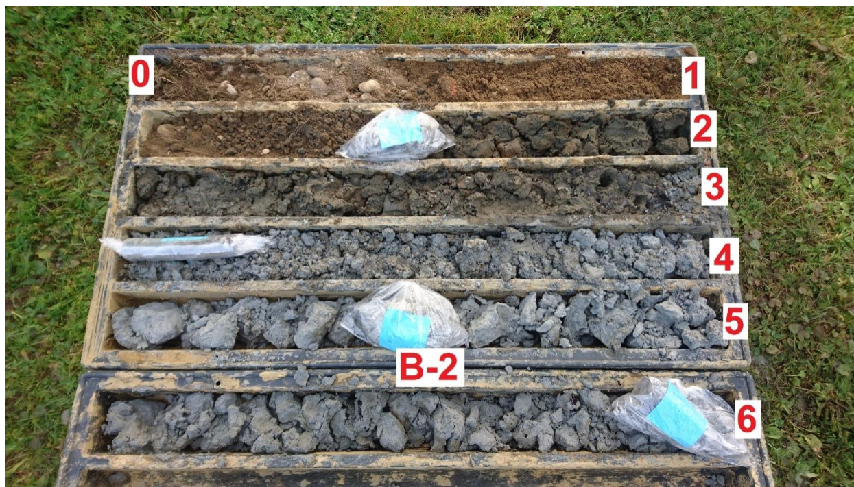
Slika 2.2. Spremanje poremećenog uzorka uzetog iz jezgre
