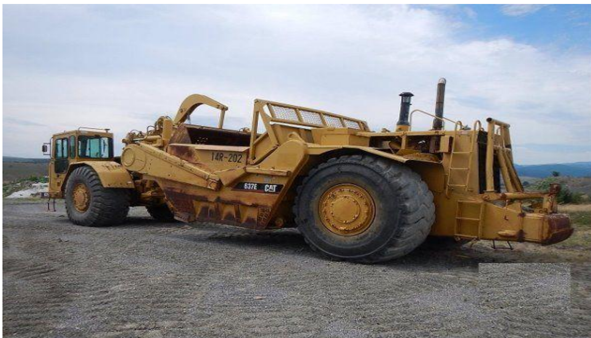
Slika 16. Skrejper - namjensko vozilo za prijevoz i grubo razastiranje
