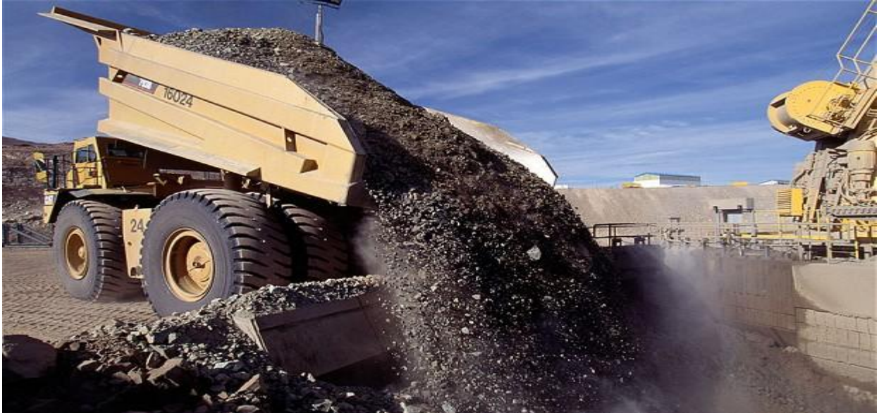
Slika 15. Odlaganje s grubim razastiranjem iz dampera
