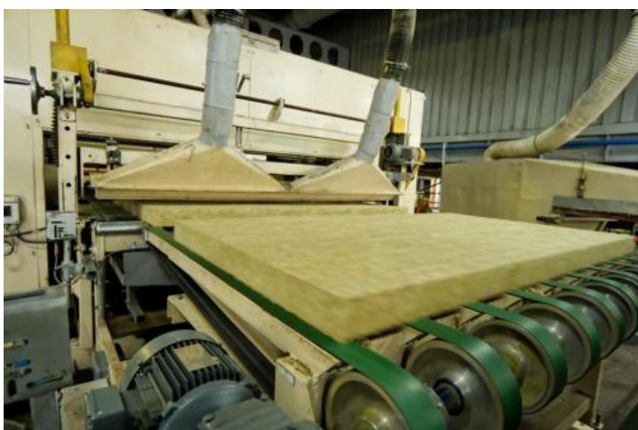
Slika 9. Rezanje vune na željene dimenzije
