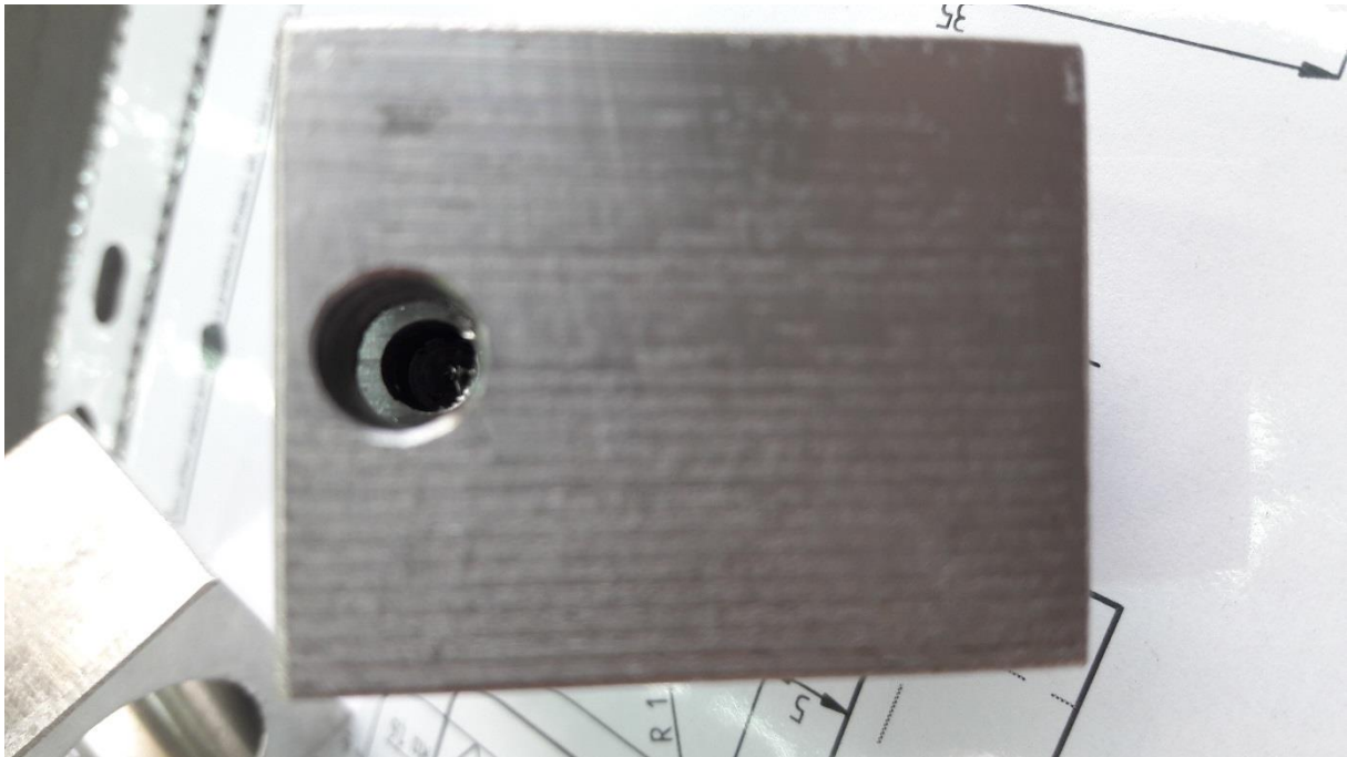
Slika 4.49. Pozicija bez izrađenog navoja na mjestu provrta (uvećano)
