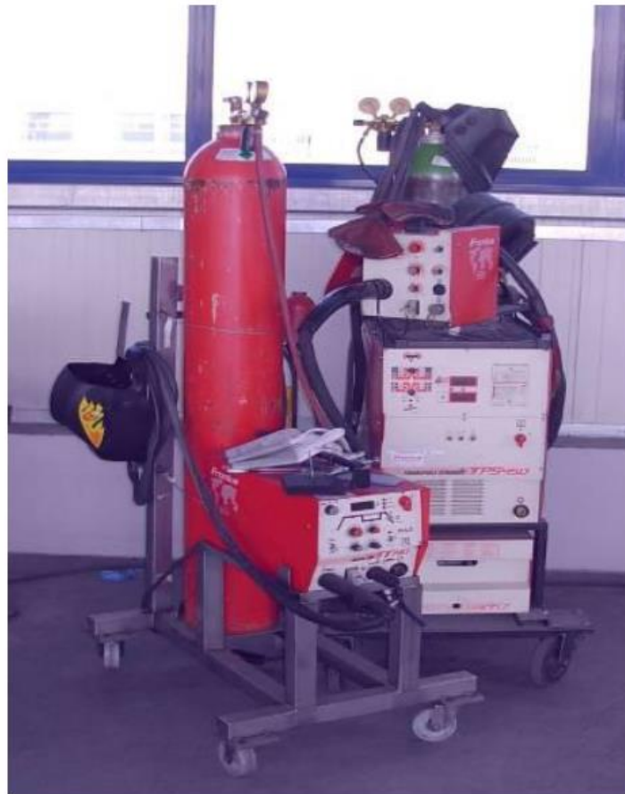
Slika 4.10. Aparat za zavarivanje [10]
