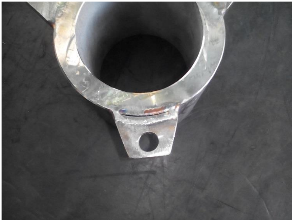
Slika 4.52. Greška kod zavarivanja – neprovareni korijen zvara
