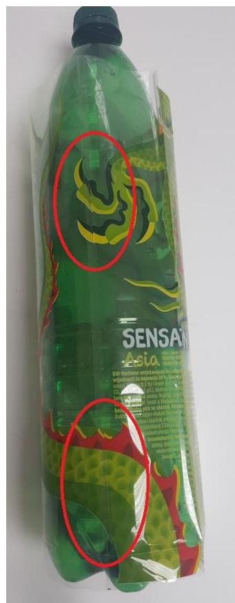
Slika 36. Preklop kod sleeviranja
