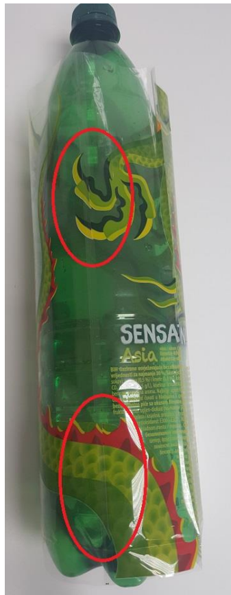
Slika 36. Preklop kod sleeviranja
