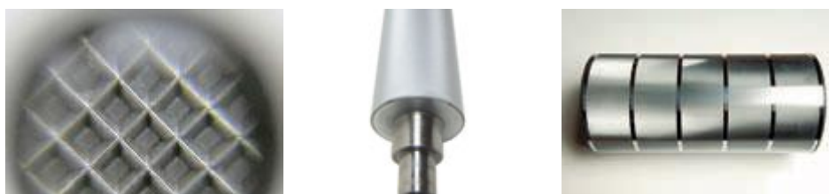
Slika 14. Rasterski valjci (aniloks)
