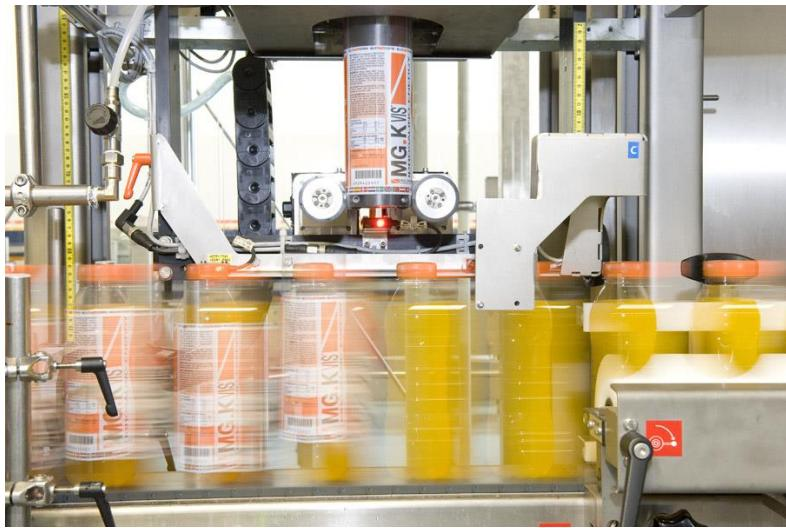
Slika 30. Stroj za sleeviranje
