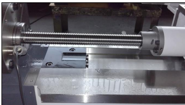
Slika 7.11: Kuglično navojno vreteno „Z“ osi
