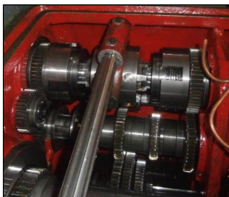
Slika 7.7: Prijenosnici glavnog prigona univerzalnog tokarskog stroja
