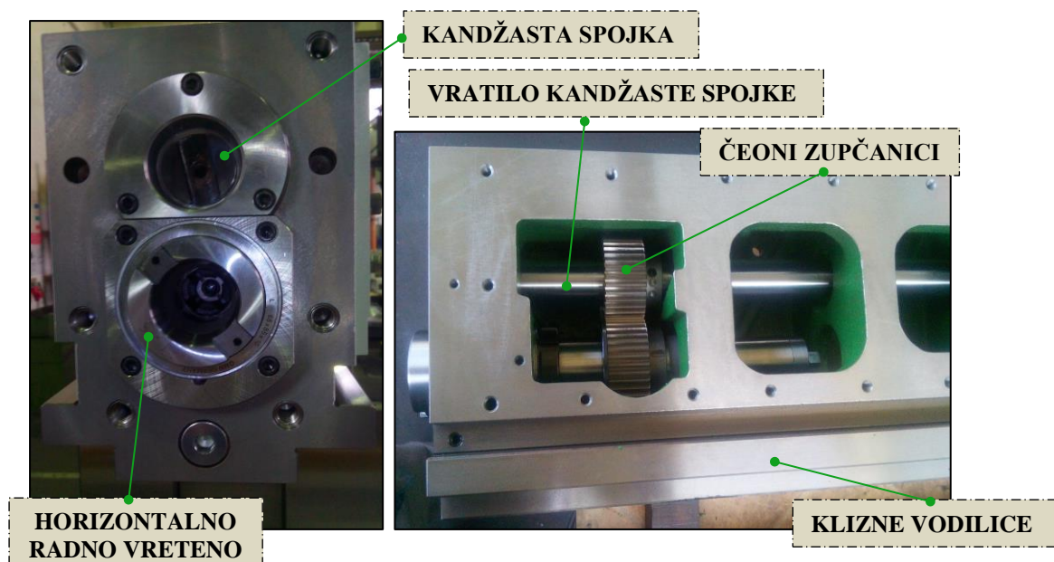
Slika 7.19 : Vretenište CNC glodalice
