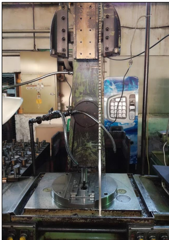
Slika 5.15: Stroj za provlačenje
