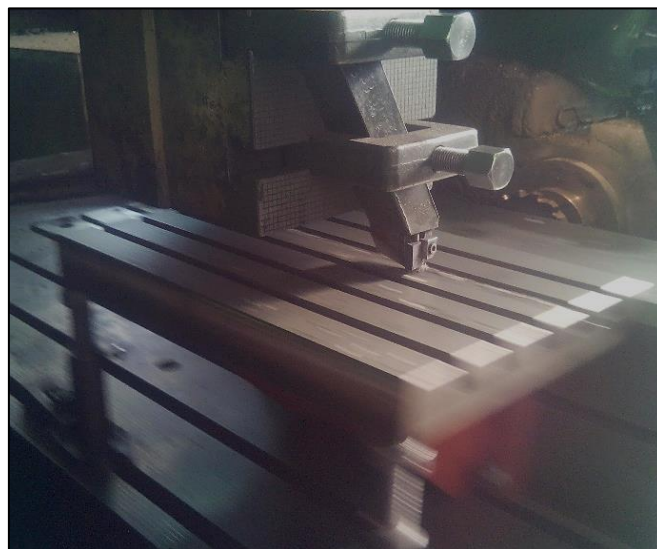
Slika 5.13: Portalno (dugohodno) blanjanje pritezne plohe radnog stola glodalice
