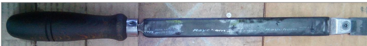
Slika 8.3: Grečalo sa oštricom od tvrdog metala
