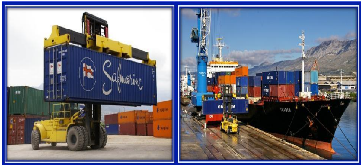
Slika 12. Kontejnerski manipulator i mobilna lučka dizalica u luci Split
