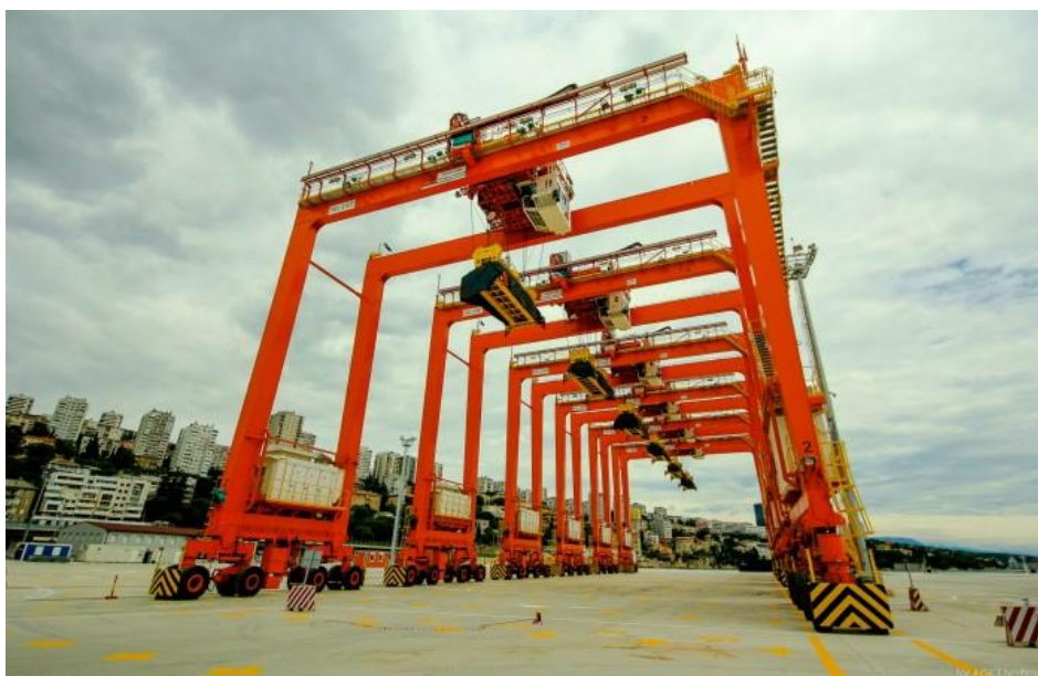
Slika 9. Mosne kontejnerske dizalice na kotačima marke „ZPMC“
