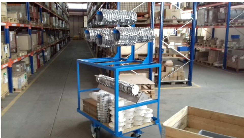
Slika 3.17. Junjo kit kolica za pripremu krupnog materijala po sekvencama [28]
