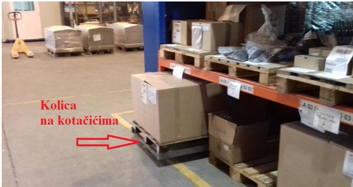
Slika 3.19. Izvlačna kolica u supermarket skladištu [28]
