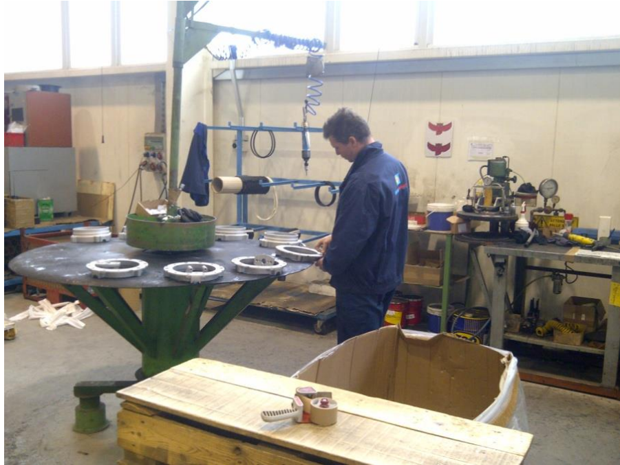
Slika 3.3. Montaža leptirastog ventila na rotacionom stolu [28]
