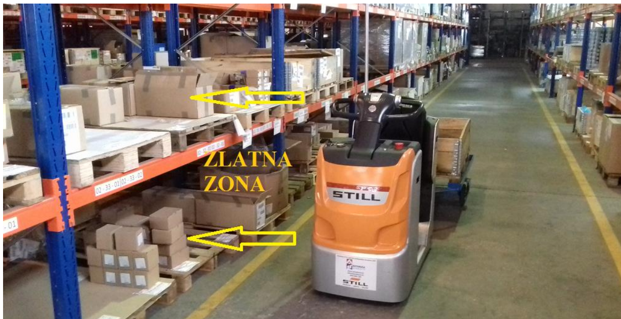
Slika 3.18. Vučno vozilo na lokaciji supermarket skladišta „zlatna zona“ [28]
