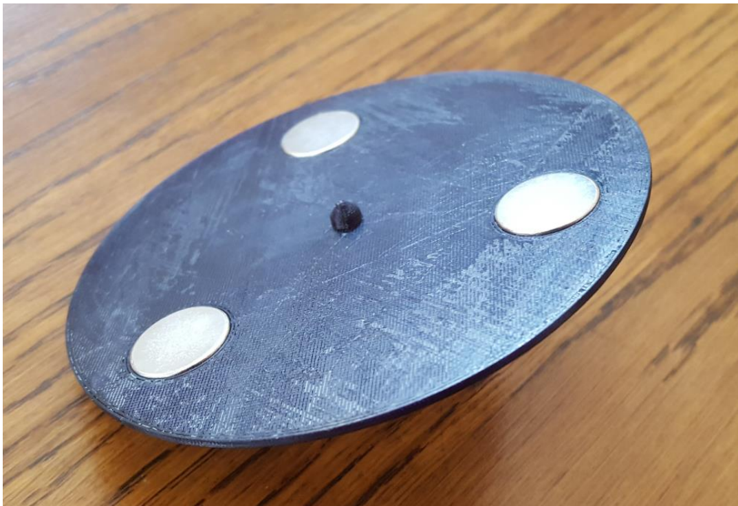
Slika 7.6. Princip spajanja neodimijskih magneta s prototipom rotora
