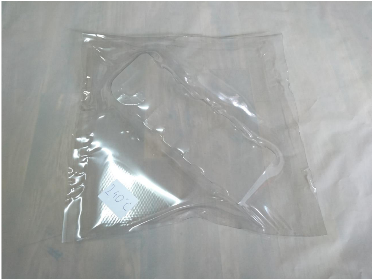
Slika 5.5 Neuspjeli pokus pri 240\text{ }^{\circ}\text{C}
