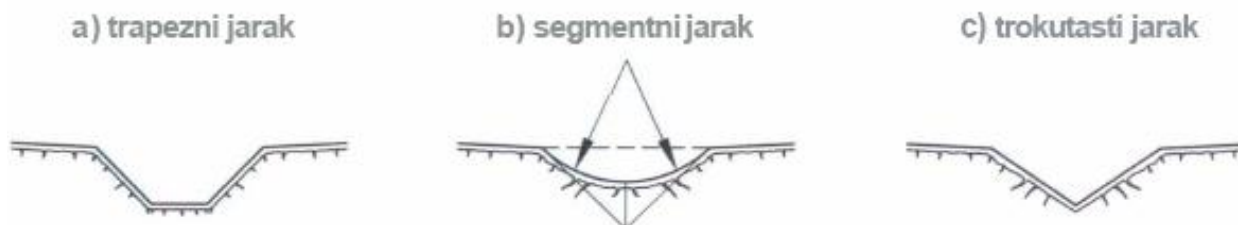
Slika 4.1: Poprečni presjeci jaraka (Rezo, 2016.)
