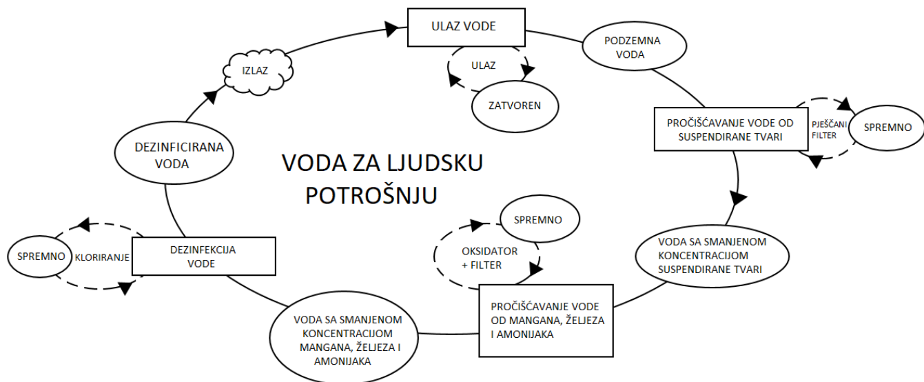
Slika 27. DCA sustava za pročišćavanje podzemne vode
