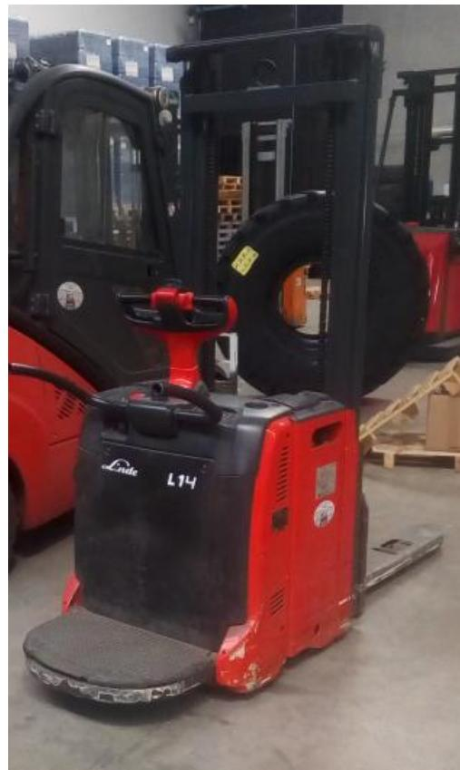
Slika 4.10. : Ručni električni viličar Linde L14 AP
