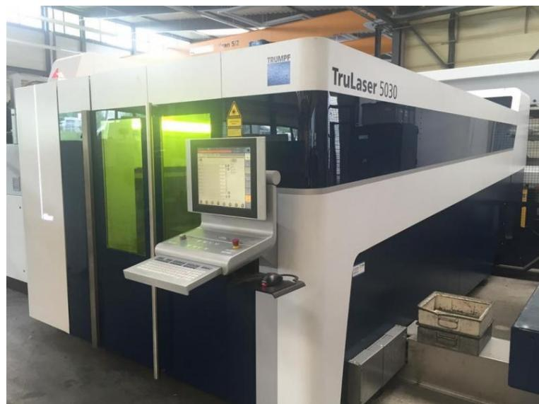
*Slika 7. Stroj za rezanje lima laserom*
