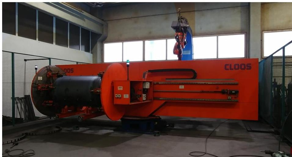
*Slika 6. Robot za zavarivanje akumulacijskih spremnika*
