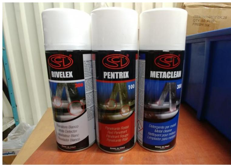
*Slika 21. Penetrant, razvijač i čistač*
