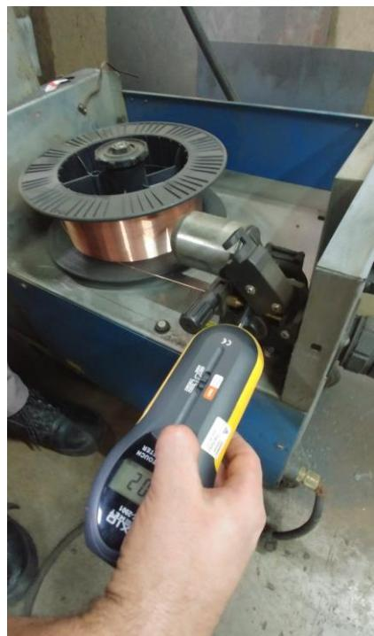
Slika 18. Mjerjenje brzine žice
