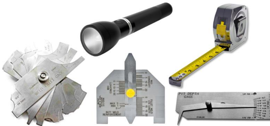
Slika 20. Primjer opreme za kontrolu zavara [20]
