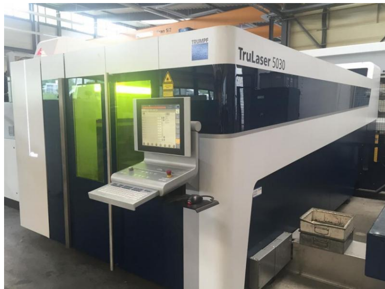
Slika 7. Stroj za rezanje lima laserom
