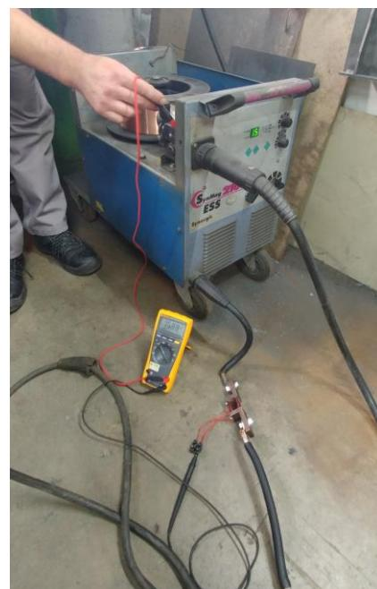
Slika 17. Mjerenje jakosti struje zavarivanja
