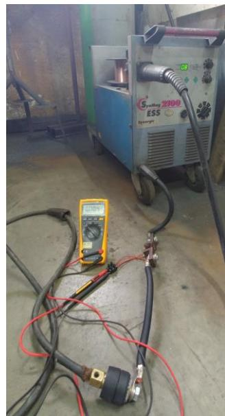
Slika 16. Mjerenje napona praznog hoda
