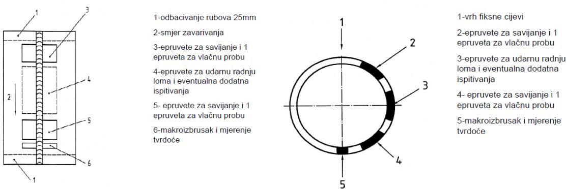
*Slika 10. Izgled ispitnih uzoraka za sučevni i sučevni spoj cijevi [17]*
