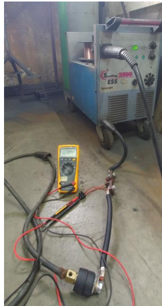
Slika 16. Mjerenje napona praznog hoda
