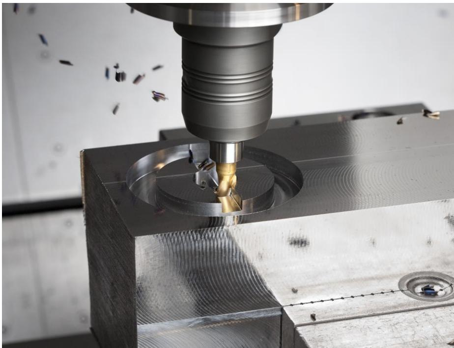
*Slika 18. Visokobrzinska obrada kod izrade kalupa [9]*
