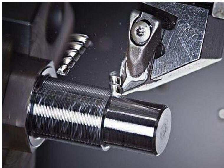
Slika 19. Tokarenje otvrdnutog materijala [10]
