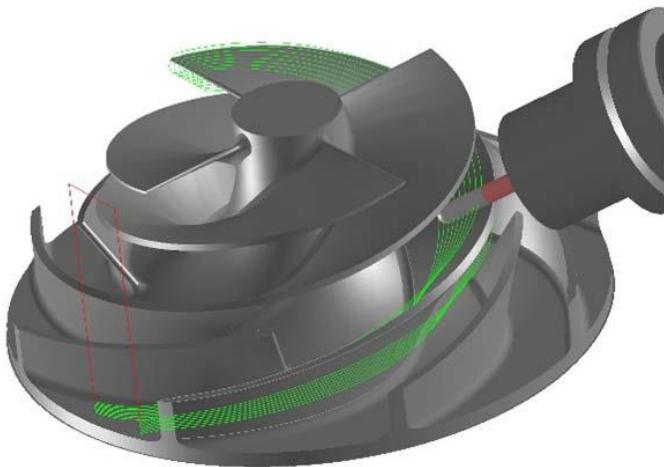
Slika 7. Primjer simultane obrade [5]
